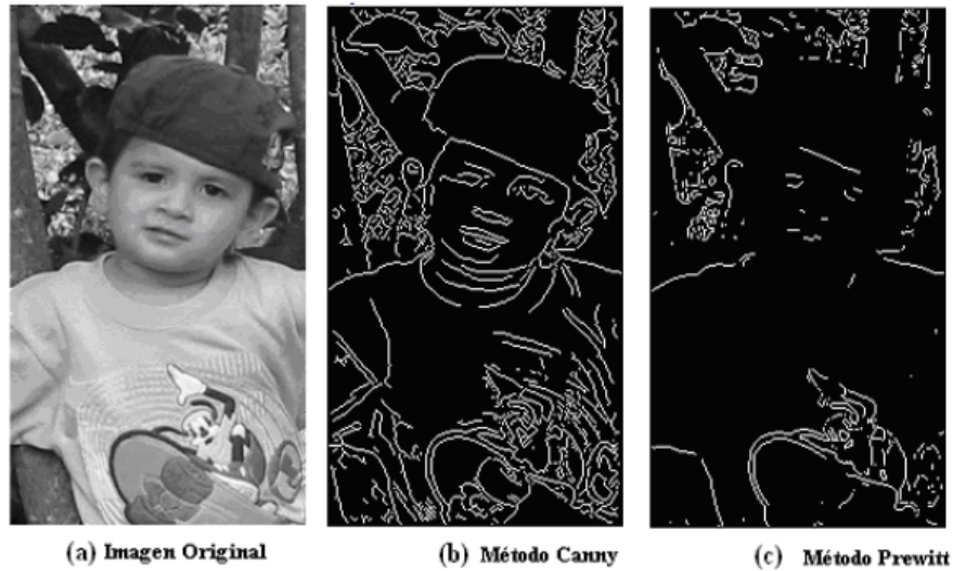
Figura 2.27: Comparación del método de Canny y Prewitt Fuente: Detección de bordes de una imagen, Departamento de Ingeniería Electrónica
