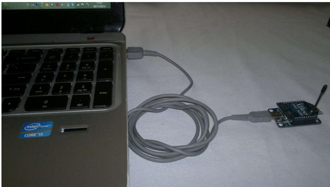
Fig. 4.6. Acoplamiento de la plataforma Arduino UNO y la XbeeShield Elaborado por: El Autor.
