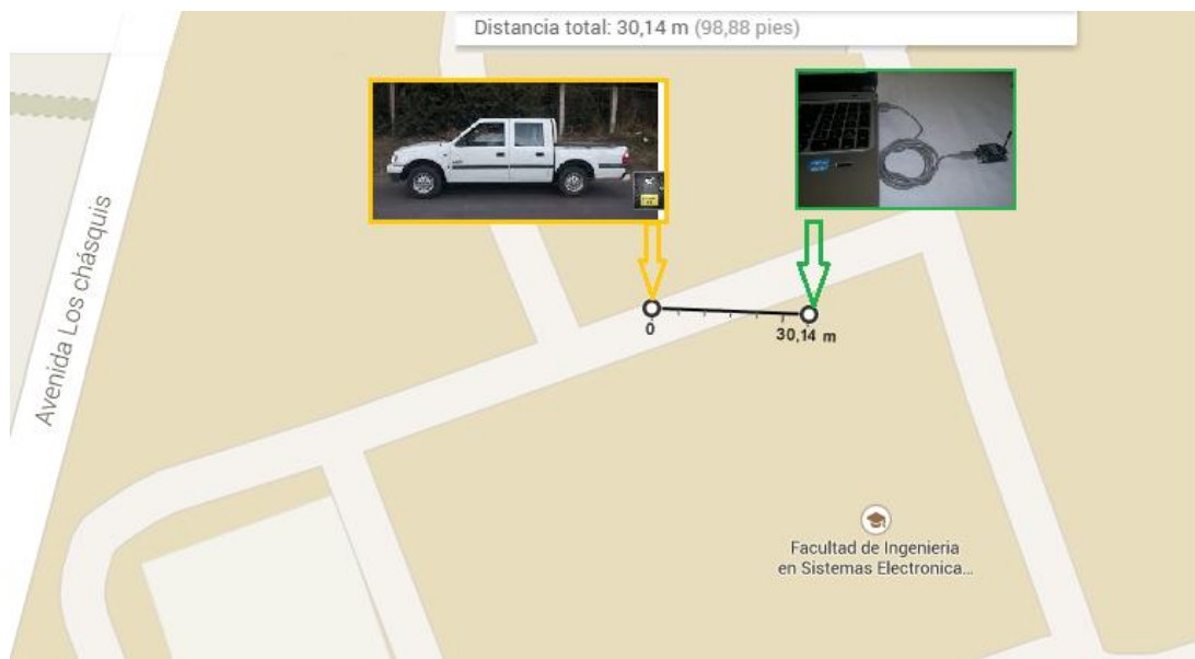
Fig. 4.19. Prueba entre la estación base y un nodo sensorial a 30m Elaborado por: El Autor.
