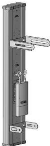
Fig. 4.26. Antena UBIQUITI AM-5G20-90 armada junto con Ubiquiti ROCKET M5.
