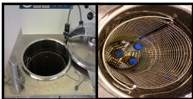
Fig. # 16: Preparación de los medios de cultivo en el autoclave
