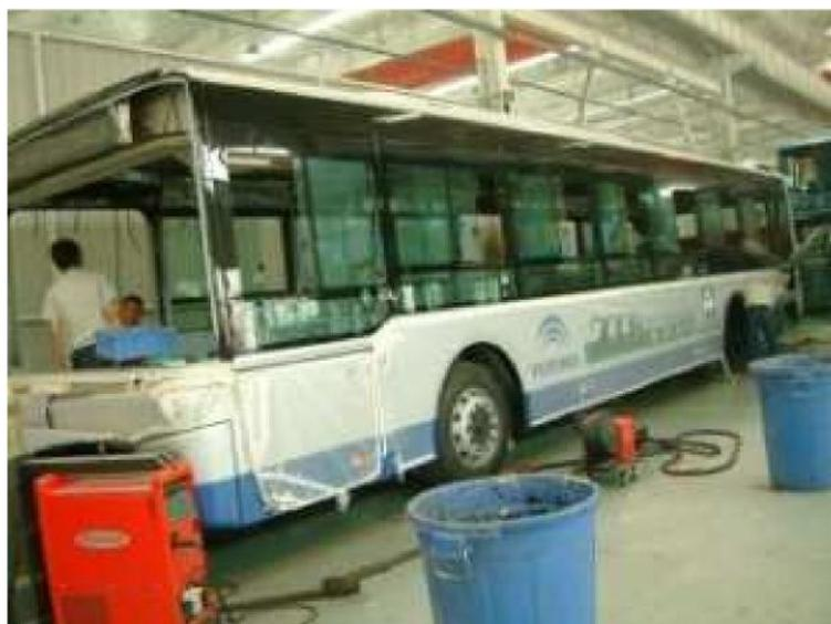
Figura 2.4. Bus con carrocería de aluminio fabricado por Zhengzhou Yutong Bus Company
