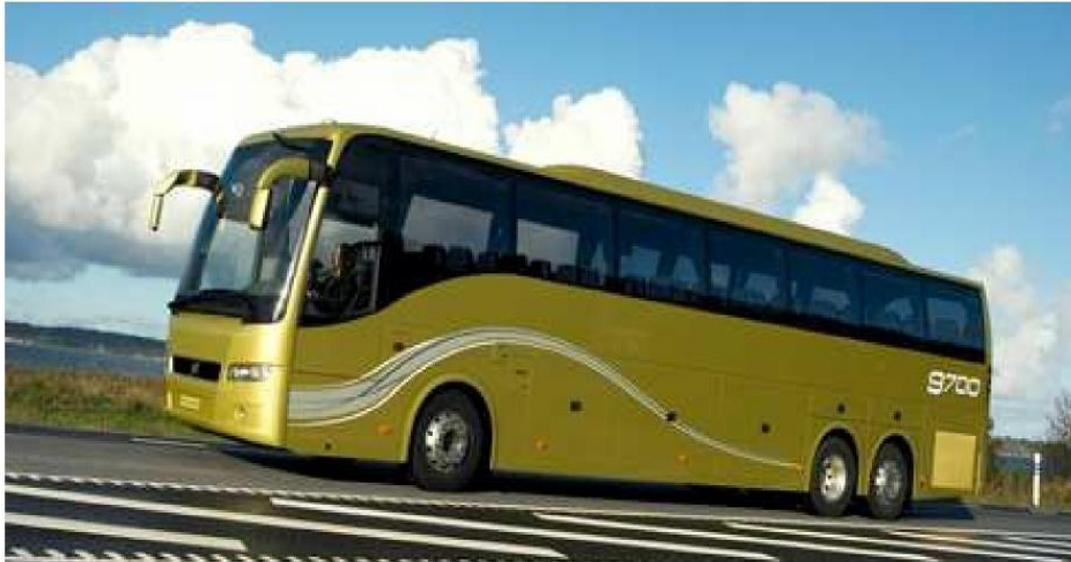
Figura 2.2. Bus Volvo con carrocería de acero inoxidable.
