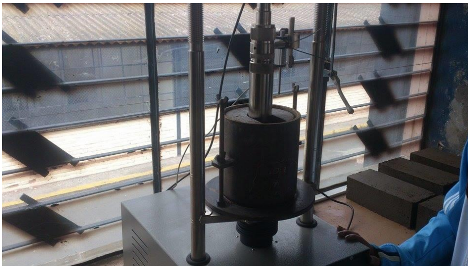
Ensayo de CBR
