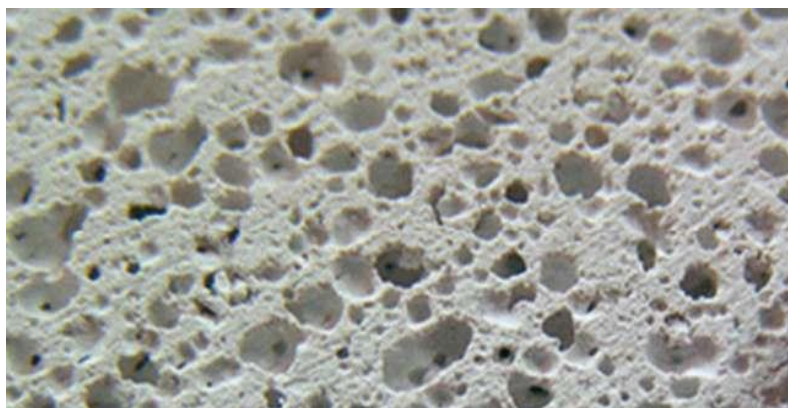
GRÁFICO N.-1 Estructura del hormigón de baja densidad una vez cumplida la etapa de fraguado.
