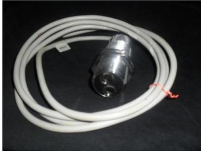
**Figura 6.6.** Sensor Fotoeléctrico
