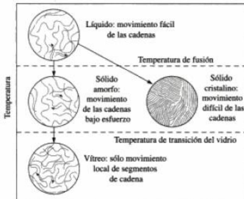
**Figura 2.2.** Efecto de la temperatura en la estructura y en el comportamiento de los materiales termoplásticos.<sup>1</sup>
