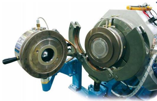
**Figura 2.14.** Cabezal granulador.
