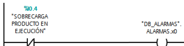
Figura 101. Alarma de Sobrecarga del producto en ejecución.
