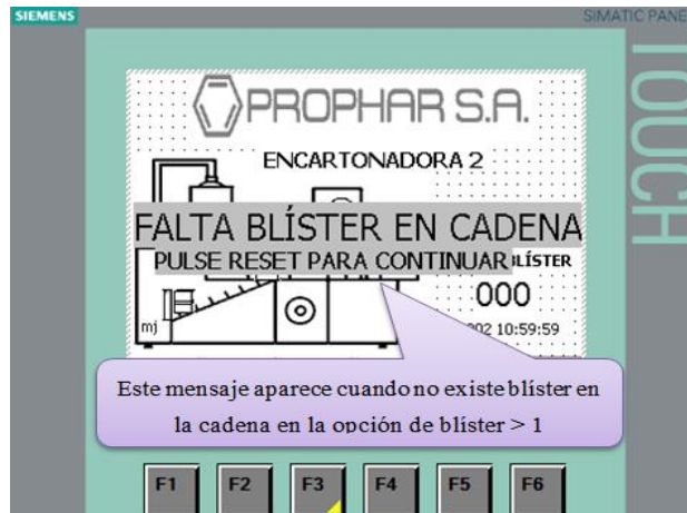
Figura 120. Mensaje cuando no existe blíster en la cadena.
