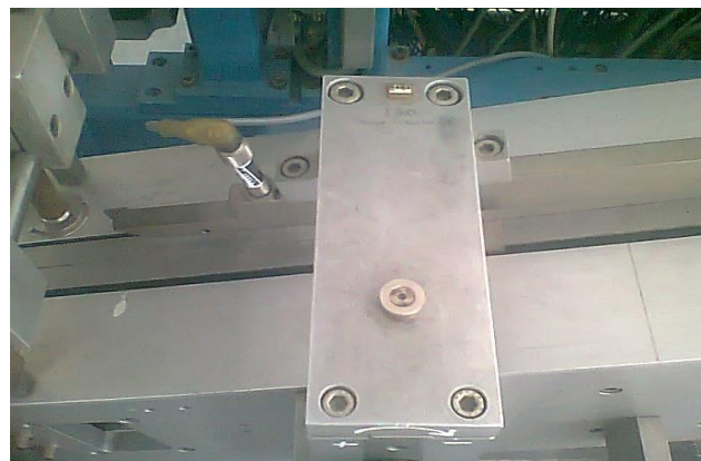
Figura 146. Acople del sensor a la estructura de la encartonadora.
