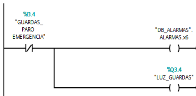
Figura 107. Alarma de Activación de guardas.
