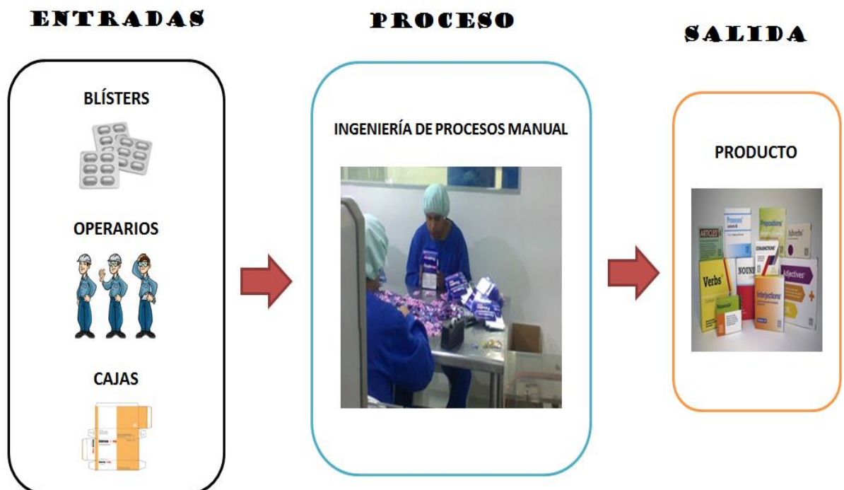
Figura 21. Proceso manual del empaquetado de blísters.
