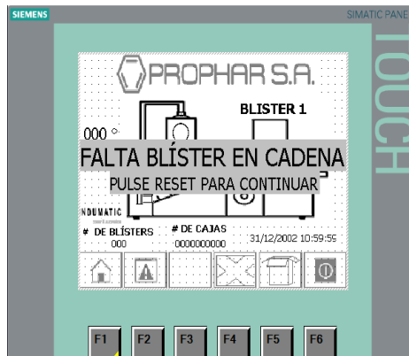
Figura 5.-Mensaje de activación
