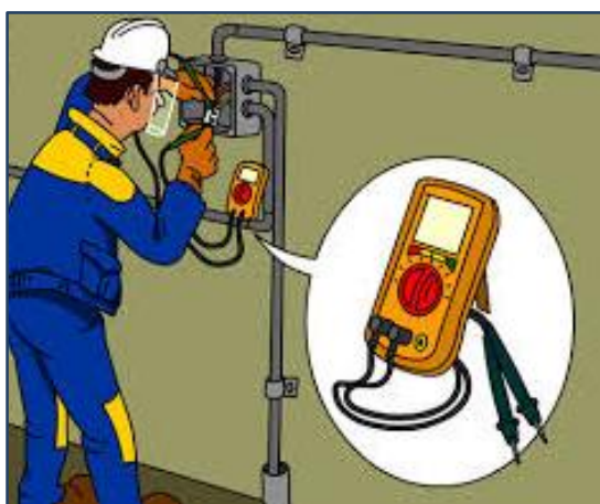
Figura 58 Revisión de ausencia de tensión
