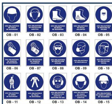
Figura 55 Señalética de los elementos y equipos de protección personal
