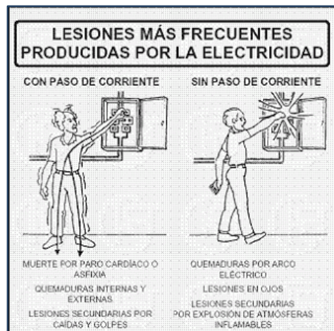
Figura 6 Daño producido por la electricidad [20]
