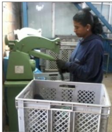
Figura 6.- Eliminación de exceso mediante e refilado de la suela.
