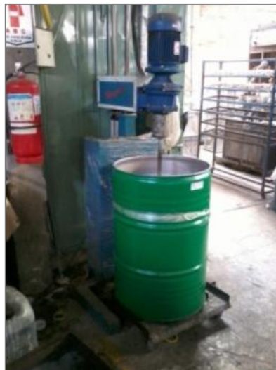
Figura 4.- Mezcla de material con ayuda de máquina.
