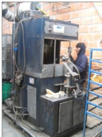
Figura 8.- Pintura de suela mediante soplete.
