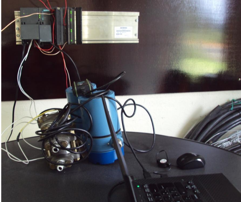
Figura 4 .27: Calibración de los sensores
