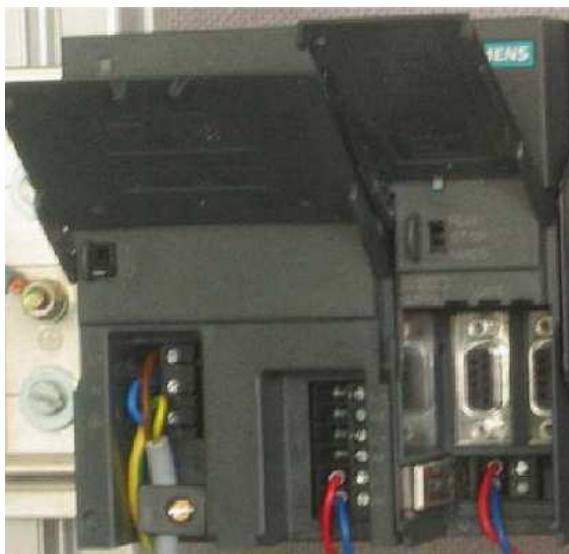
Figura 4 .29: Conexión de la fuente de alimentación PS 307 y del CPU 314
