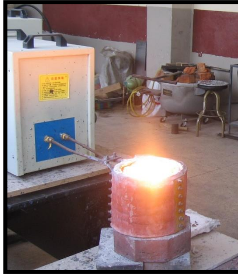
Figura 6.11 Cobre totalmente fundido en el crisol.
