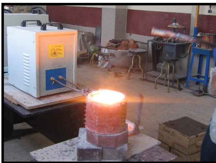
Figura 4. 4 Crisol con aleación en estado líquido dentro de la bobina del horno de inducción.
