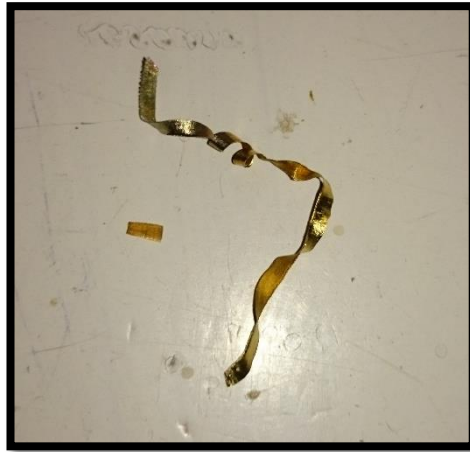
Figura 4. 45 Viruta deformada por acción de una fuerza externa (prueba 8).
