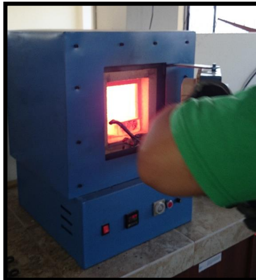
Figura 6. 24 Probetas calentadas en el horno eléctrico de mufla hasta 850°C.
