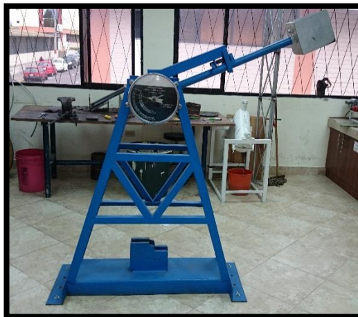
Figura 6. 39 Martillo del péndulo asegurado en la posición superior
