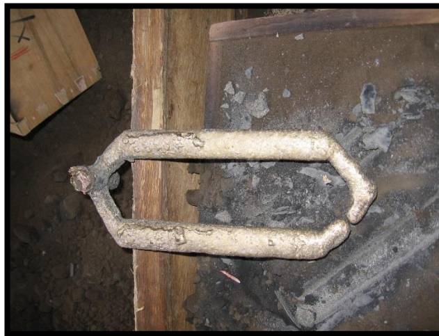
Figura 4. 22 Probetas defectuosas extraídas del molde de arena.
