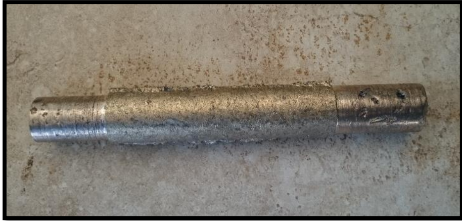
Figura 4. 31 Presencia de poros superficiales en la probeta de la prueba 5.
