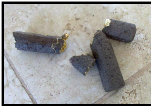
Figura 4.40 Probeta 7 rota al sacarla del horno eléctrico de mufla.
