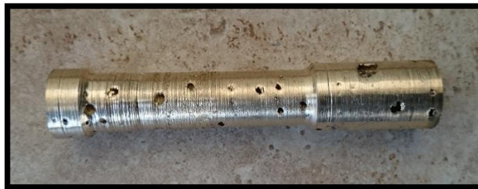
Figura 4. 16 Prueba con exceso de poros.
