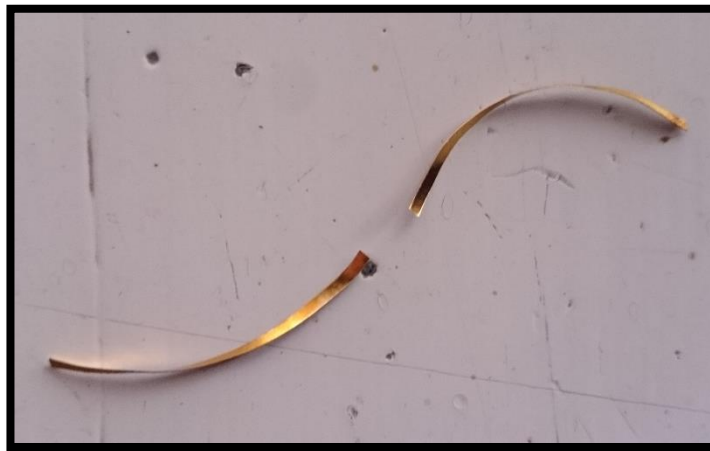
Figura 4. 18 Viruta deformada por acción de fuerza externa (prueba 2).
