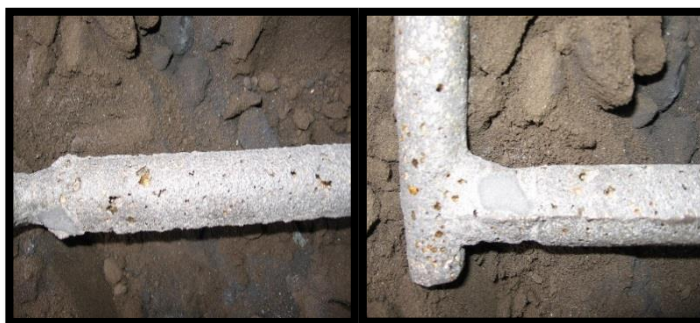
Figura 4. 26 Probeta defectuosa con poros y rechupes.
