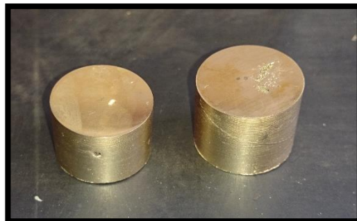
Figura 6. 34 Probetas lijadas y pulidas para el ensayo de dureza.
