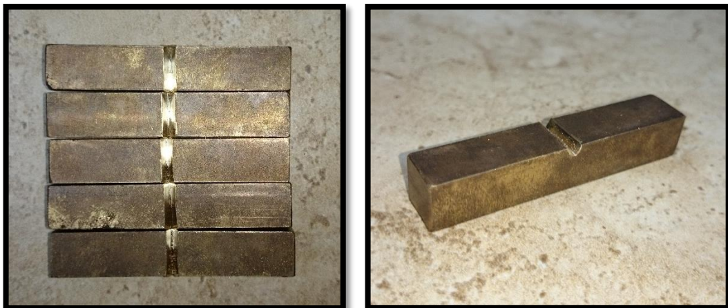
Figura 6. 21 Probetas para ensayo Charpy mecanizadas bajo norma.
