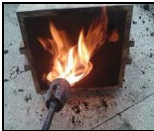
Figura 6. 9 Secado y calentado del molde con soplete.
