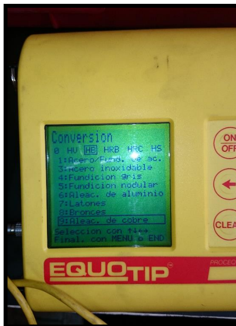
Figura 6. 36 Durómetro programado para medir dureza en aleaciones de cobre.
