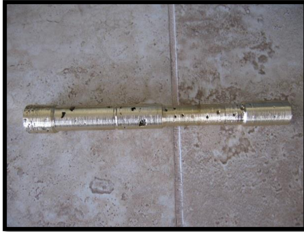
Figura 4. 10 Probeta mecanizada con exceso de poros.
