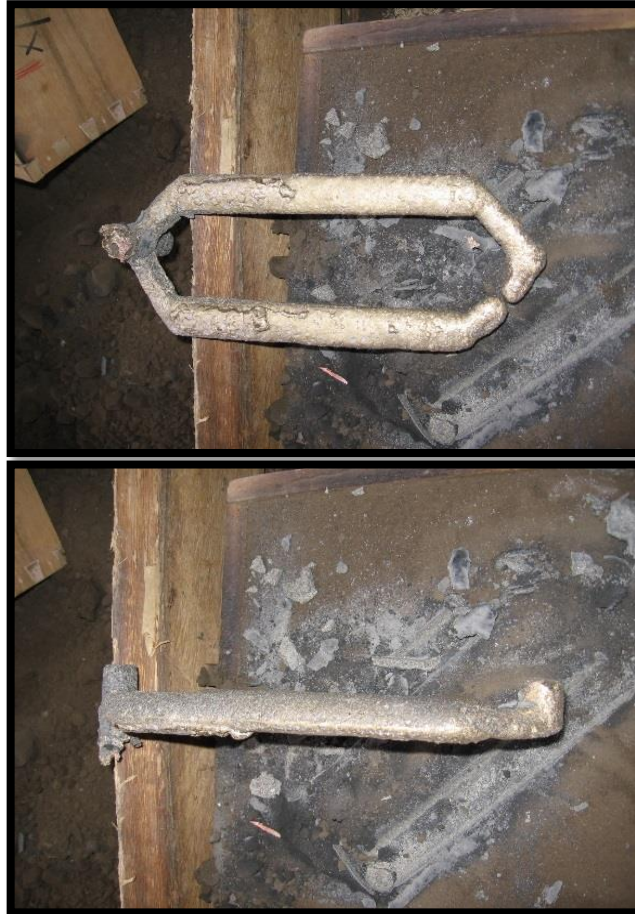
Figura 4. 19 Probetas de la prueba 3 extraídas del molde de arena.
