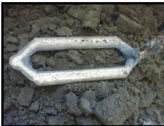
Figura 4.5 Probetas obtenidas después de desmoldar.
