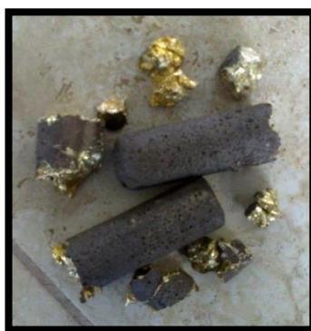
Figura 4. 37 Probeta 6 rota al sacarla del horno eléctrico de mufla.
