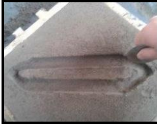
Figura 6. 8 Canales de conexión del molde abierto.
