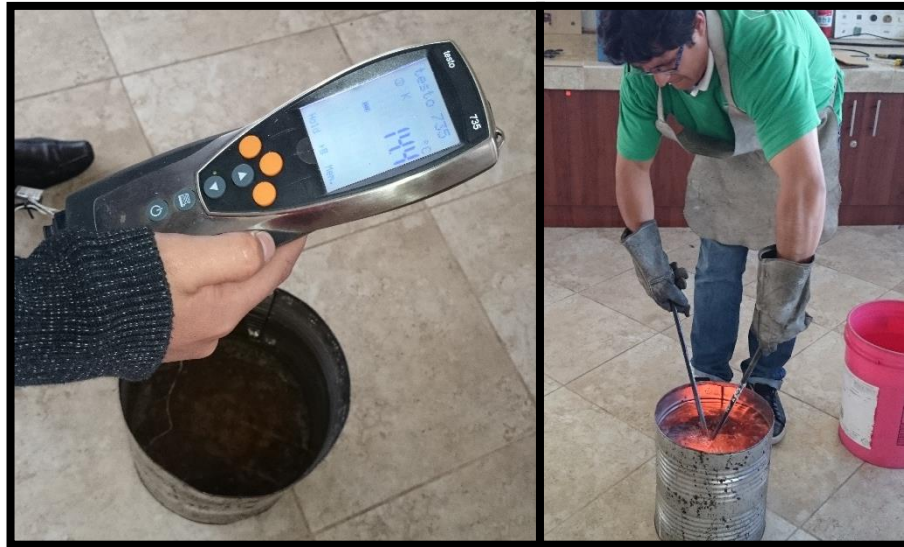
Figura 6. 25 Temperatura del agua y enfriamiento de las probetas.
