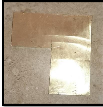
Figura 6. 19 Lingote prismático del que se extrajeron las probetas para el ensayo de impacto.
