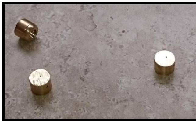
Figura 6. 27 Probetas cortadas con el Discotom.
