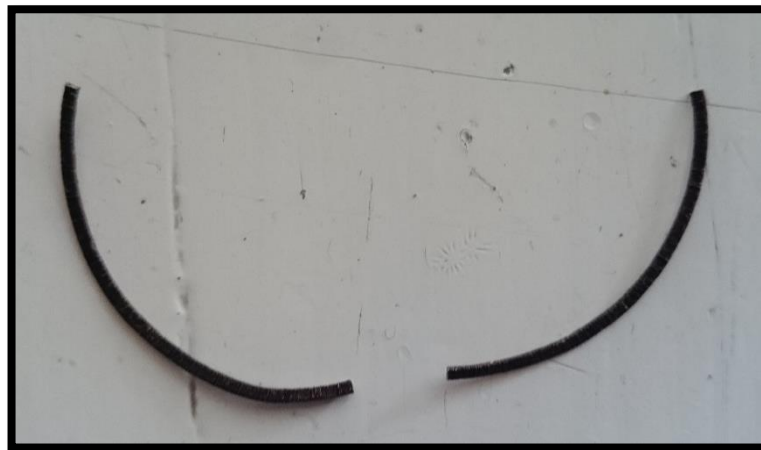
Figura 4. 12 Viruta deformada y rota por acción de fuerza externa (prueba 1).
