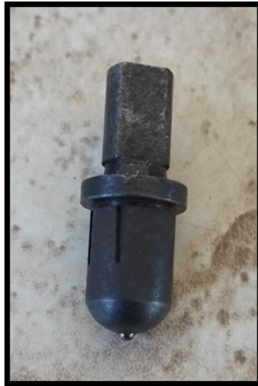
Figura 4.35 Identador de esfera de acero de 1/16" utilizado para medir dureza Rockwell B.
