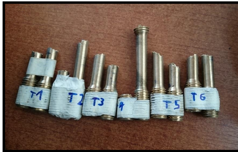
Figura 4. 44 Probetas rotas de la prueba 8 después de realizado el ensayo de tracción.
