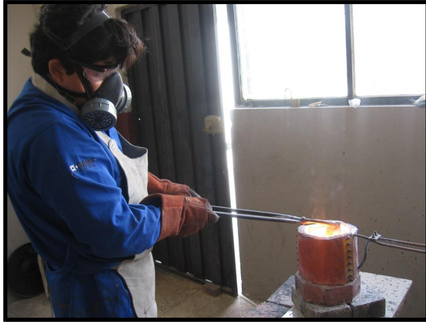
Figura 6.13 Adición del níquel a la colada.
