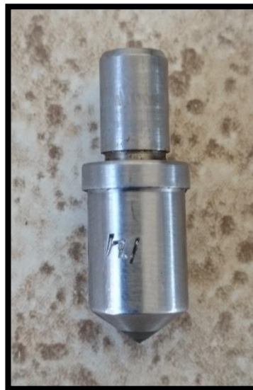
Figura 4.30 Identador de cono de diamante para medir dureza Rockwell C.
