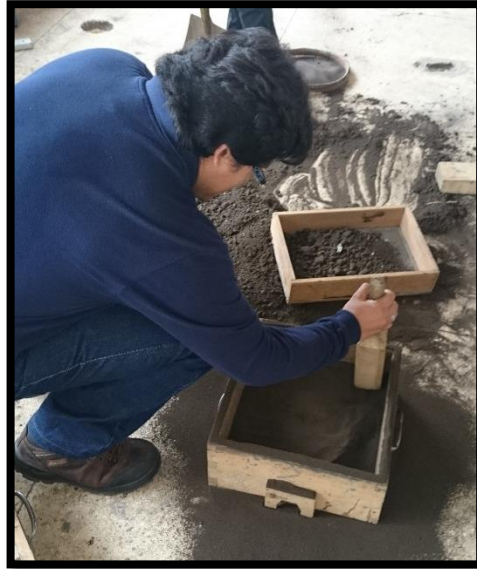
Figura 6. 6 Apisonado de la arena de relleno.
