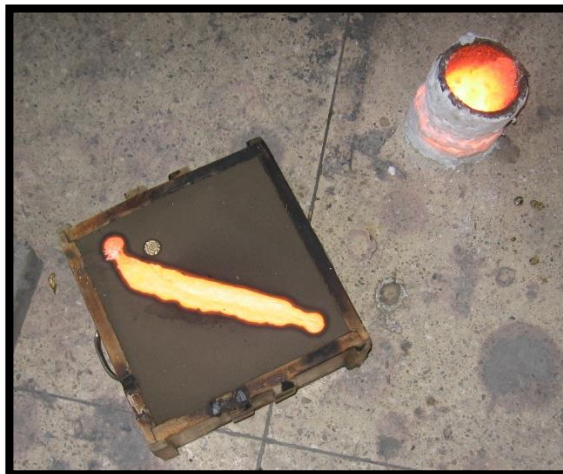
Figura 6.15 Colada vaciada en el molde abierto.
