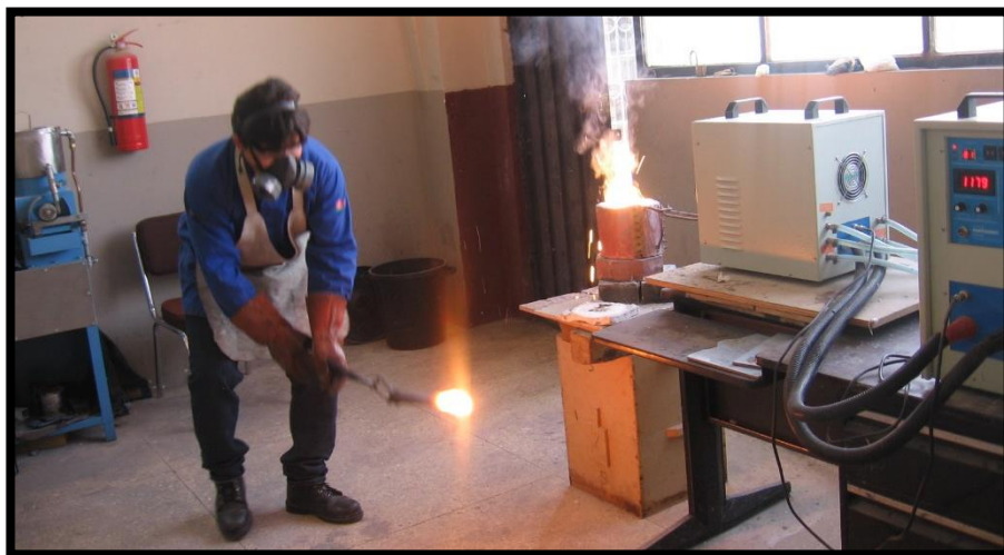
Figura 6.12 Reacción exotérmica al mezclarse el cobre y el aluminio.
