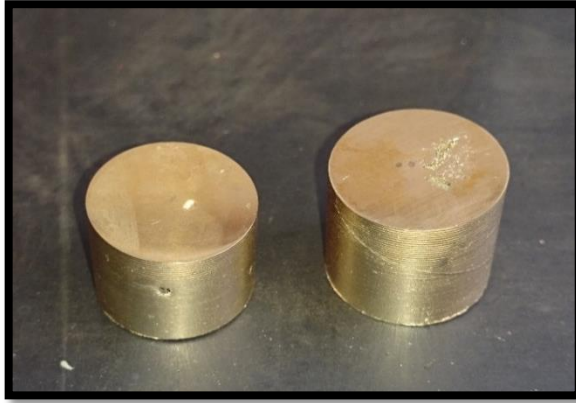
Figura 4. 43 Probetas de la prueba 8 templadas utilizadas para el ensayo de dureza.
