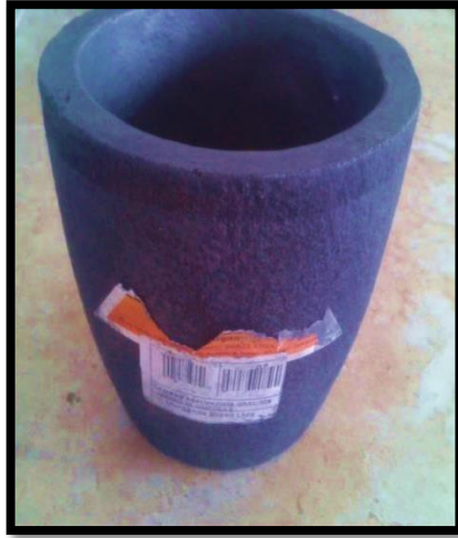
Figura 4. 2 Crisol de grafito DIAMANT/BRASIL A-6 (5 ¼”).
