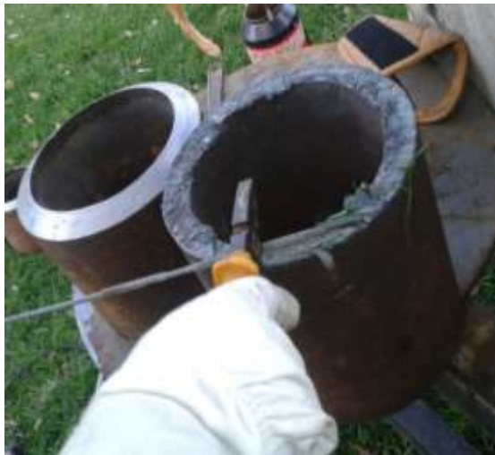
Grafico 6.1. Preparación de probetas para soldadura Elaborado por: Mauricio Adame
