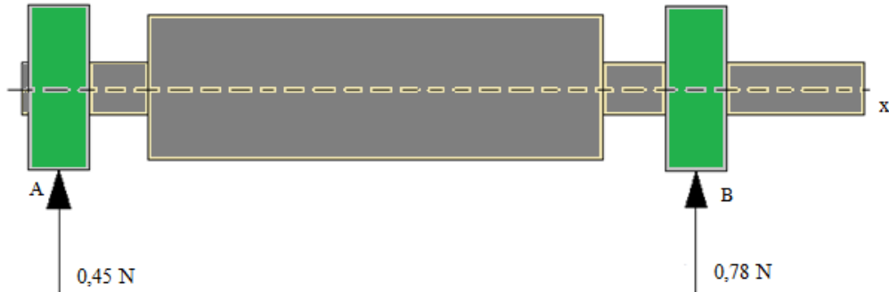
Figura 6.15 Cargas Radiales en eje conducido
