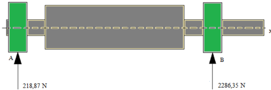
Figura 6.14 Cargas Radiales en eje motriz
