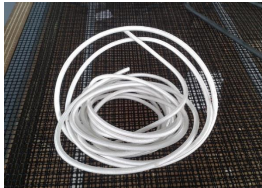
ANEXO D6: Cable de asbesto
