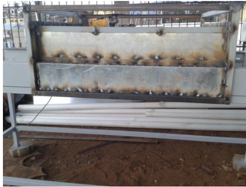
Figura 63: Estructura cámara térmica
