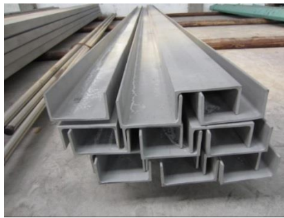
Figura 52: Perfil estructural en U
