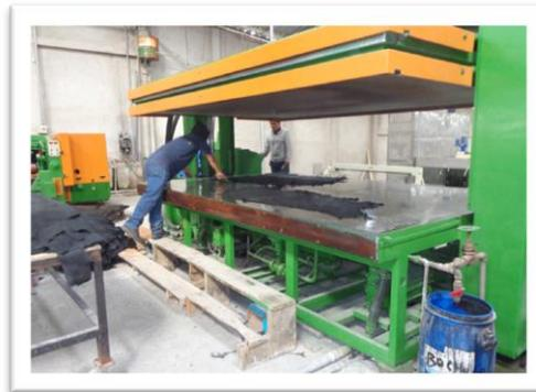
**Fig. 13.** Máquina de vacío.
