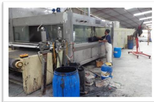
**Fig. 16.** Accionamiento de pigmentadora e ingreso al túnel de vapor.
