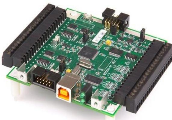
*Figura 2. 4. Tarjeta de adquisición de datos DAQFlex USB 7204, 12 bits.*
