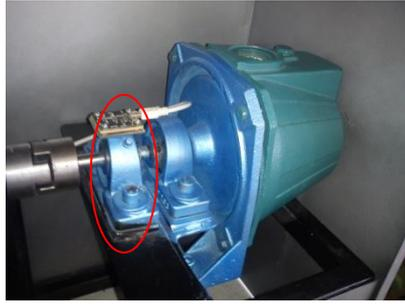
**Paso 3:** Sustituir la chumacera de pared (1) por la deteriorada, ajustar el eje de la bomba con los prisioneros de la chumacera.
