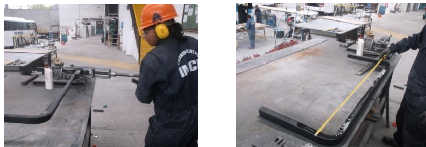
Figura 6.6: Doblado del material y verificación de medidas.
