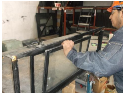
Figura 6.13 Colocación de correderas.
