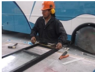
Figura 6.15 Verificación de medidas pulido de la soldadura.
