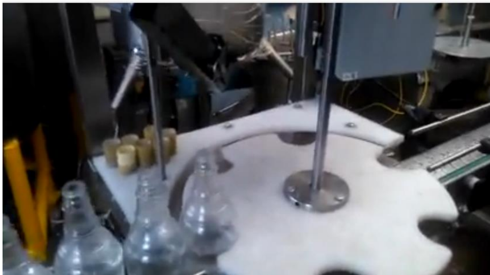
Figura 2.6: Posicionador rotatorio con mecanismo de cruz de malta
