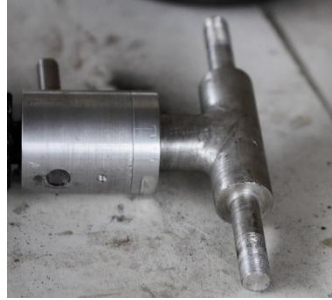
Figura 6-11 Ensamblaje unión con la te.
