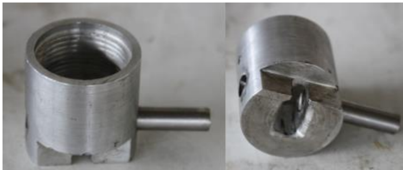
Figura 6-8 Construcción de la unión.
