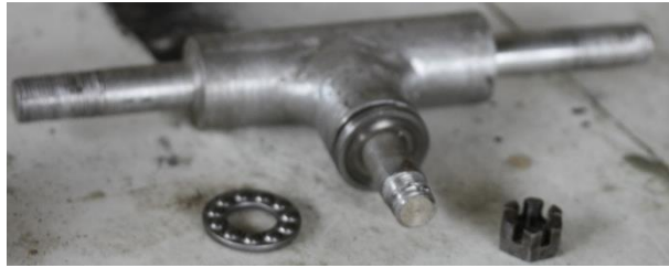
Figura 6-7 Construcción de la te.
