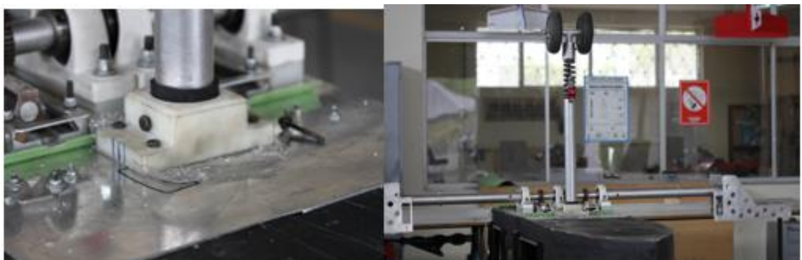
Figura 6-13 Ensamblaje del tren de aterrizaje en la góndola.
