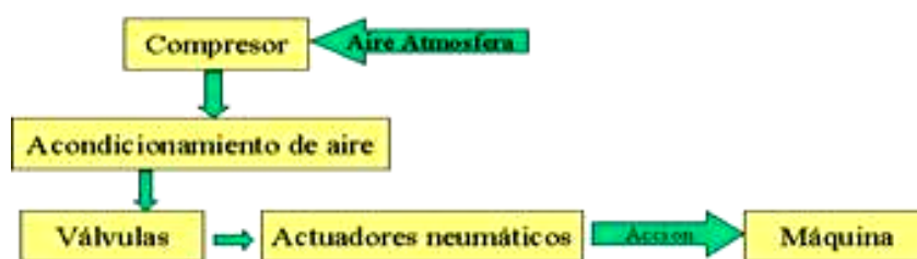
Fig. 2.2 Sistema de aire comprimido
