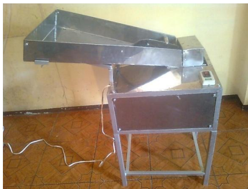
Fig. 6.17 Picadora Automatizada (vista lateral)
