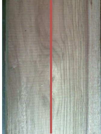
FIGURA N° 2.27. Grano desviado en la madera. [Fuente: Propia imagen capturada por el autor]
