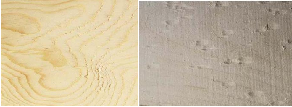
FIGURA N° 2.34. a) Grano desgarrado, b) grano astillado. [Fuente: http://www.almamater.edu.co/Memorias.PDF/3.Defectos.de.Madera_Alberto.Londono_UT.pdf ]
