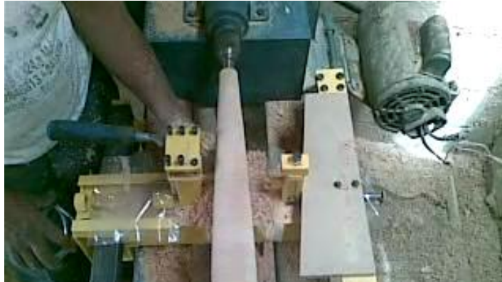
FIGURA N° 4.2. Torneado de piezas cónicas en la Carpintería Mayorga. [Fuente: Propia imagen capturada por el autor.]
