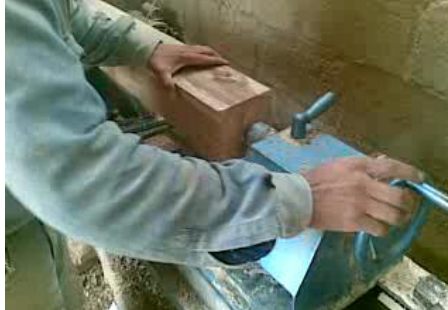
FIGURA Nº 2.10. Fijación de la pieza de trabajo. [Fuente: Propia imagen capturada por el autor]
