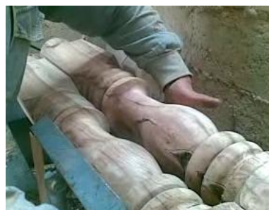
FIGURA N° 2.7. Verificación de diámetros en piezas torneadas en Carpintería Mayorga. [Fuente: Propia imagen capturada por el autor]
