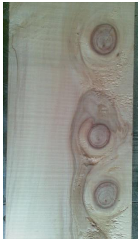
FIGURA N° 2.28. Nudos presentes en la madera. [Fuente: Propia imagen capturada por el autor]
