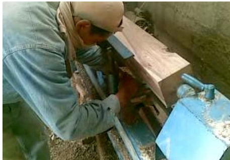
FIGURA Nº 2.11. Ajuste de la herramienta de soporte. [Fuente: Propia imagen capturada por el autor]
