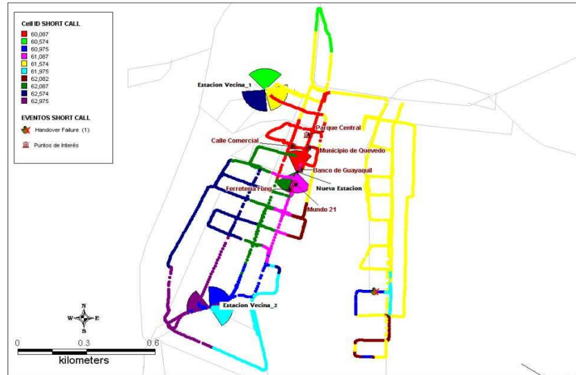
Figura 6.52 Análisis de drive test – Cell ID
