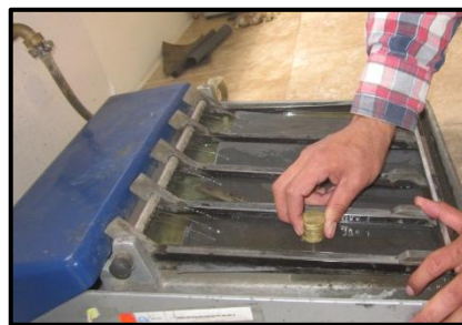
Figura. 6.7: Desbaste grueso de la probeta en el banco de lijas. Fuente: Laboratorio de Materiales FICM – UTA.
