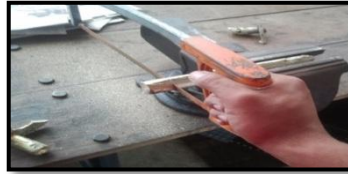
Figura. 6.2: Cortar probetas de la aleación 69.7% Cu – 23.4% Zn – 6.71% Al. Fuente: El Autor
