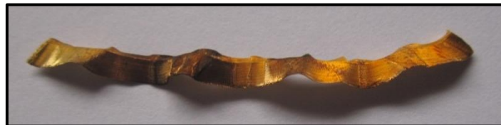
Figura. 4.7: Aleación 69.7% Cu – 23.4% Zn – 6.71% Al, sin deformar.
