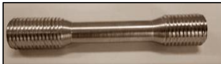
Figura. 6.17: Probeta para el ensayo de tracción según la norma ASTM E-8.
