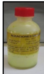
Figura. 6.12: Reactivo químico para aleaciones en base cobre que contiene 20 gr de \text{FeCl}_3 , 5 ml de \text{HCl} , 1 gr de \text{CrO}_2 , y 100 ml de agua destilada.
