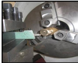
Figura. 6.3: Refrentado de la probeta. Fuente: El Autor.
