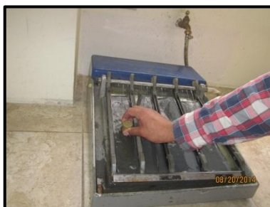
Figura. 6.8: Desbaste fino de la probeta en el banco de lijas.
