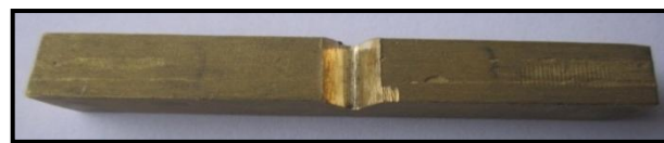
Figura. 6.21: Probeta para el ensayo de impacto según la norma ASTM E-23.
