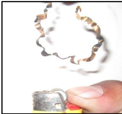
Figura. 4.10: Aleación 69.7% Cu – 23.4% Zn – 6.71% Al, al aplicar calor no recupera forma inicial. Fuente: El Autor.
