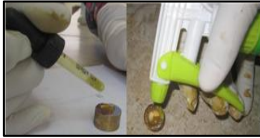
Figura. 6.13: Ataque químico de la probeta 69.7% Cu – 23.4% Zn – 6.71% Al. Fuente: Laboratorio de Materiales FICM – UTA.
