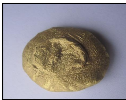
Aleación 69.7%Cu - 23.4%Zn - 6.71%Al, recocida a 900 ° C, 3h.
