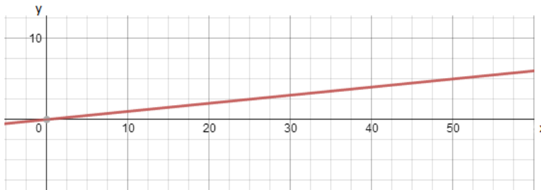
Figura 1.15.- Función de transferencia entre la salida de un transmisor y la entrada analógica de la FPGA
