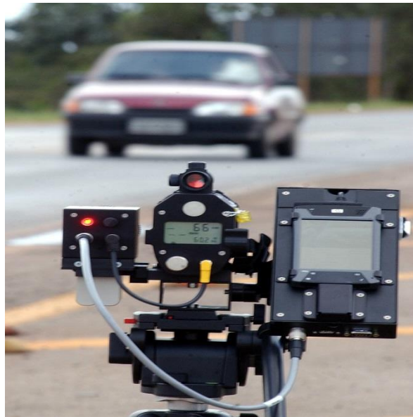
Figura N° 2.23 Fotorradar para el control de velocidad
