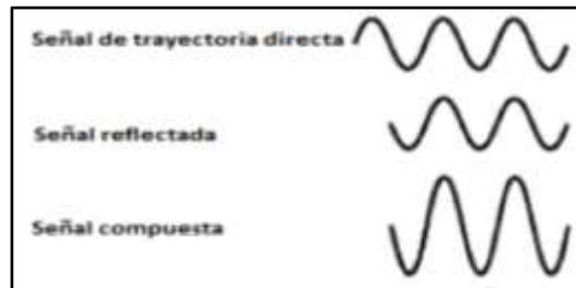
Figura N o 2.13: Interferencia, forma constructiva
