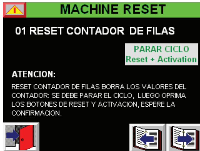
Fig. 7._ Pantalla Reset Contador de filas terminal HMI Panel View Plus 600 (Stacker)
