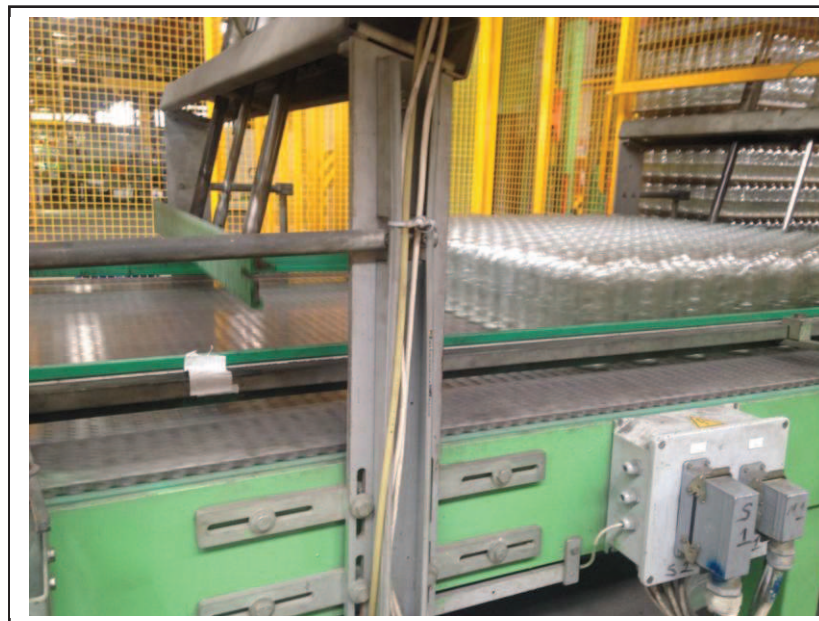
Fig. 42._ Zona de espera-Stacker L4.
