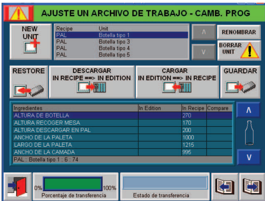
Fig. 10._ Pantalla Recetas terminal HMI Panel View Plus 1000 (Paletizador)
