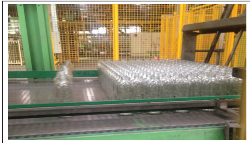
Fig. 41._ Zona de conformación de la camada-Stacker L4.
