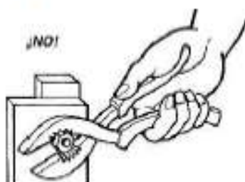
Fig. 4: Mala utilización de alicates
