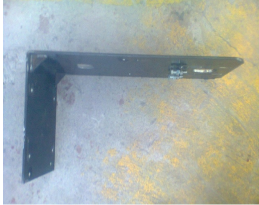
Figura 6.69. Placa L Soporte Construída
