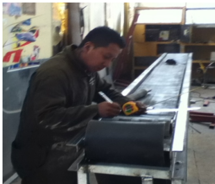
Figura 6.78. Montaje de banda
