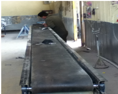
Figura 6.95. Pruebas de funcionamiento del Sistema de Transporte
