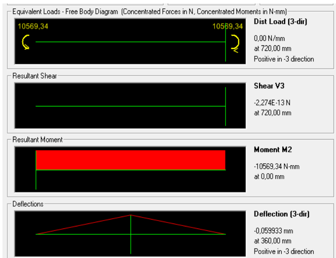
Figura 6.39. Diagrama de carga, de corte y momento flexionante en el plano xy de estructura.
