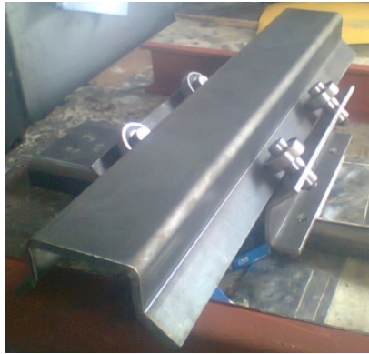
Figura 6.73. Montaje de Rodadura de Tronzadora
