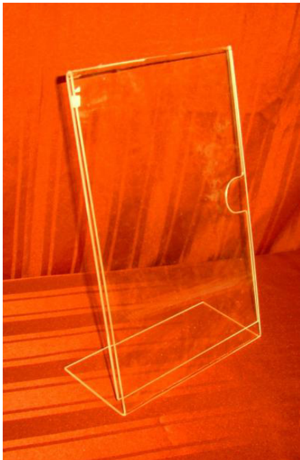
Ilustración 2-13. Mostradores fabricados de una sola pieza, por medio del doblado con calentamiento lineal.
