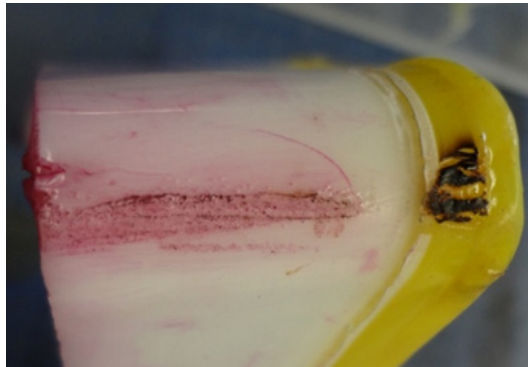
Ilustración 4-3. Craqueo y agrietamiento.
