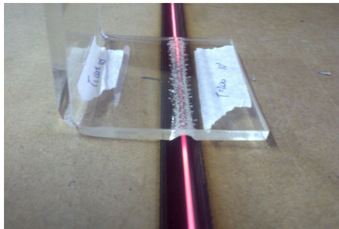
Ilustración 5-1. Placa acrílica de 5mm de espesor sometida a 200^{\circ}\text{C} durante 10 minutos.
