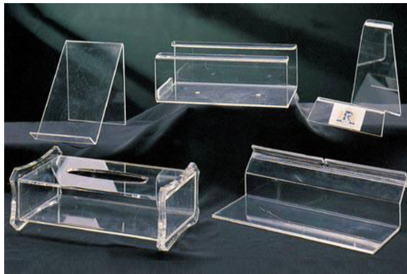
Ilustración 2-11. Variedad de geometrías obtenidas por dobleces.
