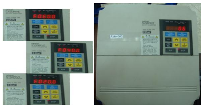
Figura 6.8.12 Frecuencia interna del variador de 15 KHZ con frecuencias de 60, 40, 20 Hz.
