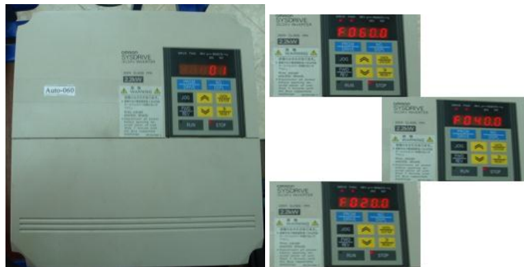
Figura 6.8.9 Frecuencia Interna 2.5 KHz, Frecuencias de variación de velocidad 60, 40, 20 Hz.
