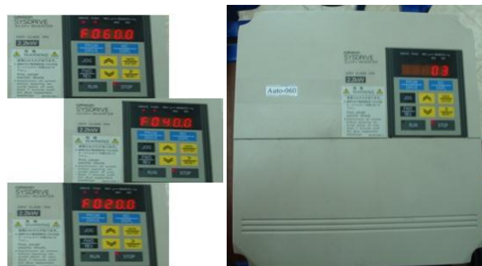
Figura 6.8.8 Frecuencia interna del variador de 7.5 KHz con frecuencias de 60, 40, 20 Hz. Fuente: Egdo. López A. Darwin A.
