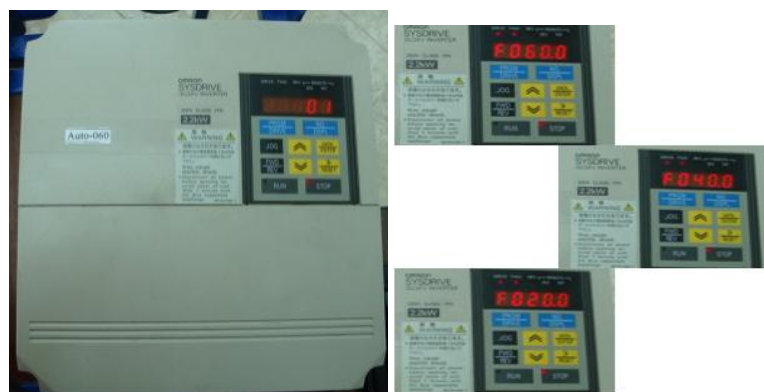
Figura 6.8.7 Frecuencia Interna 2.5 KHz, Frecuencias de variación de velocidad 60, 40, 20 Hz. Fuente: Egdo. López A. Darwin A.
