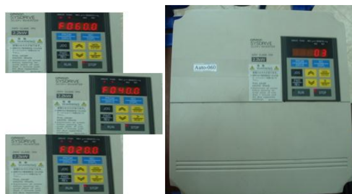
Figura 6.8.10 Frecuencia interna del variador de 7.5 KHZ con frecuencias de 60, 40, 20 Hz.
