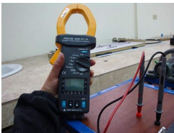
Figura 6.8.4 Analizador de armónicos conectado en paralelo.
