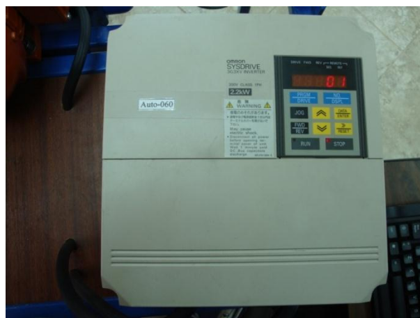
Figura 6.8.3 Variador de Frecuencia 2.5 KHz. Fuente: Egdo. López A. Darwin A.
