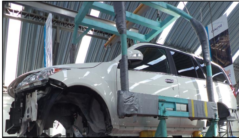
Fig. 18 Cabina ingresando a la línea de ensamble
