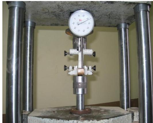
**Figura 6.13: Ensayo de tracción**
