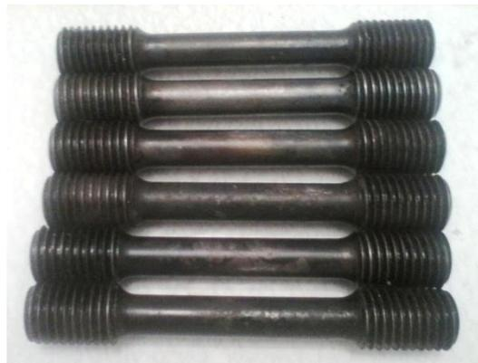
**Figura 6.2: Probetas para ensayo de tracción según norma ASTM E-8 espécimen 1.**
