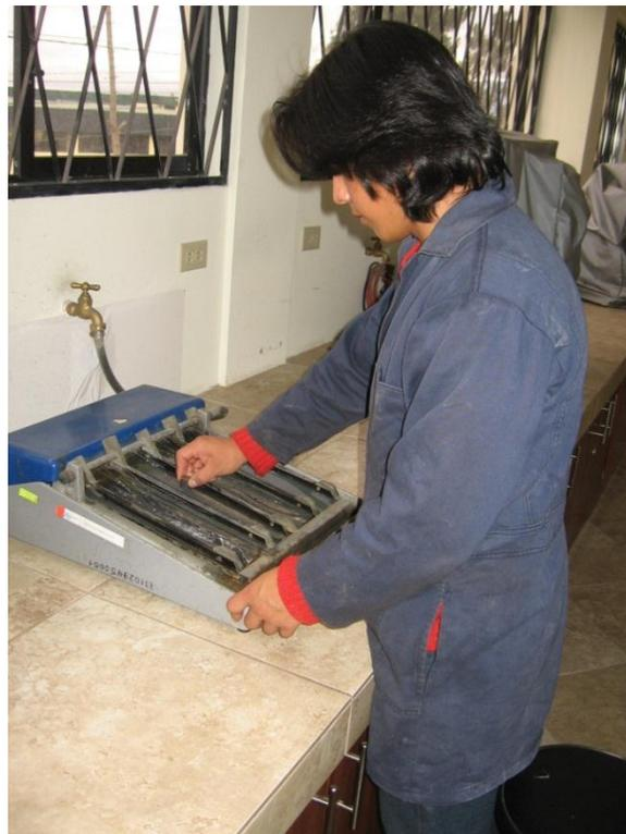
**Figura 6.8: Paso de la probeta por el banco de lijas**
