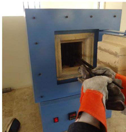
**Figura 6.5: Ingreso de probetas para ser aplicadas el primer revenido consecutivo**
