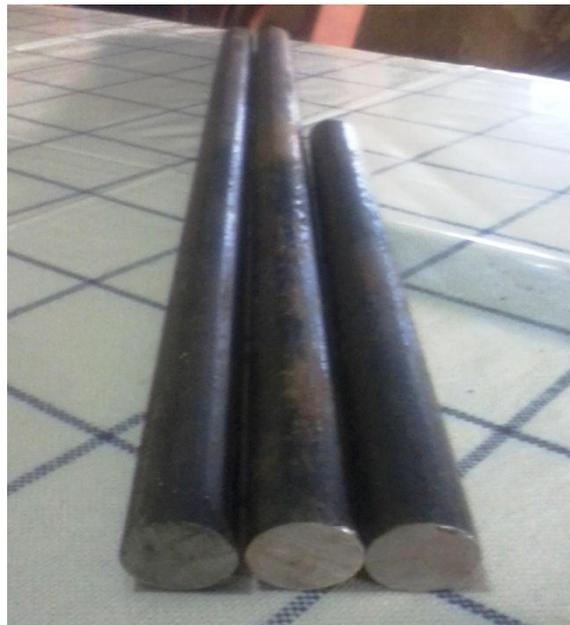
**Figura 6.1:** Eje de acero AISI 1045 de fábrica, diámetro de  $\frac{3}{4}$  de pulgada
