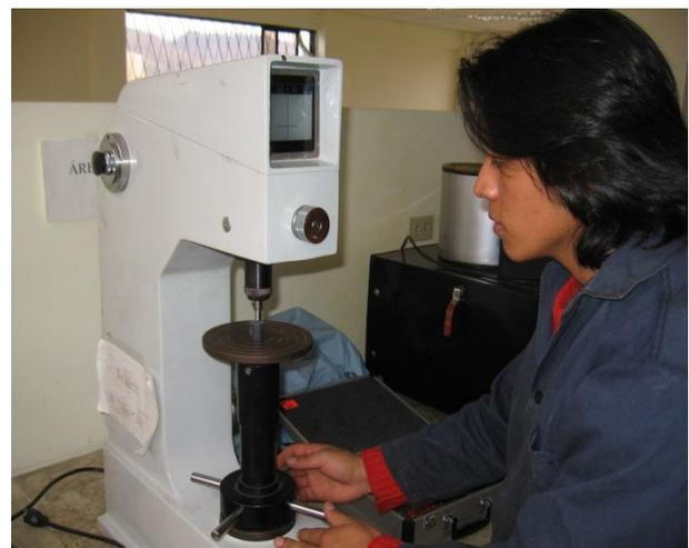
**Figura 6.15 Ensayo de dureza**
