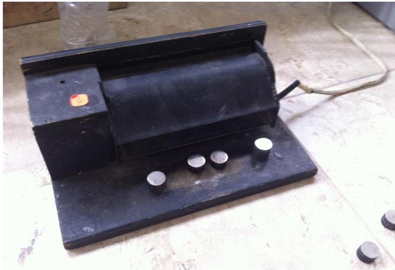
**Figura 6.10: Secado de la probeta**
