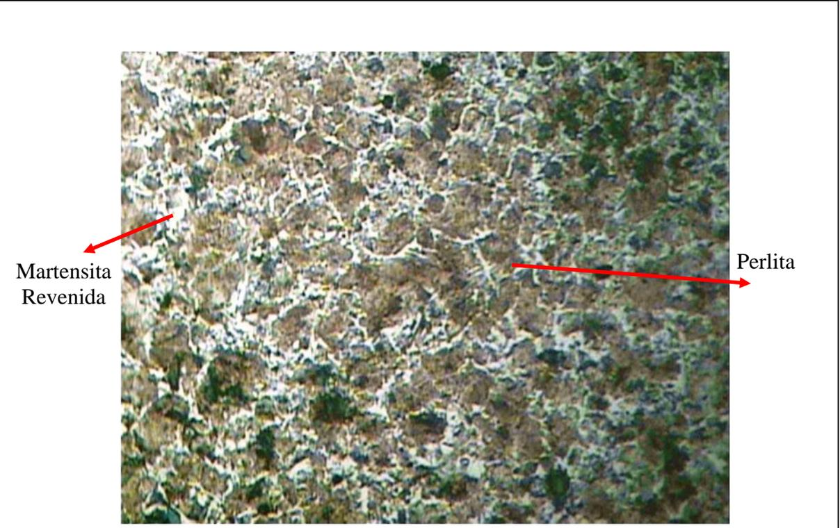
**Microestructura muestra 1.1M, 200 X, 3seg, Nital 2.**
