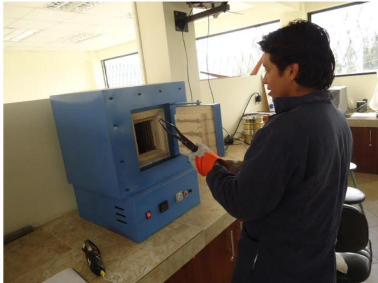
**Figura 6.6: Ingreso de probetas para ser aplicadas el segundo revenido consecutivo**
