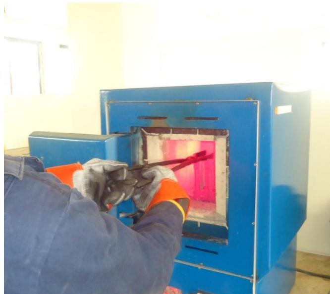
**Figura 6.3: Probetas al rojo vivo alcanzadas el tiempo y temperatura de permanencia para el temple**
