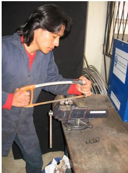
**Figura 6.7: Corte de la probeta para el análisis metalográfico**
