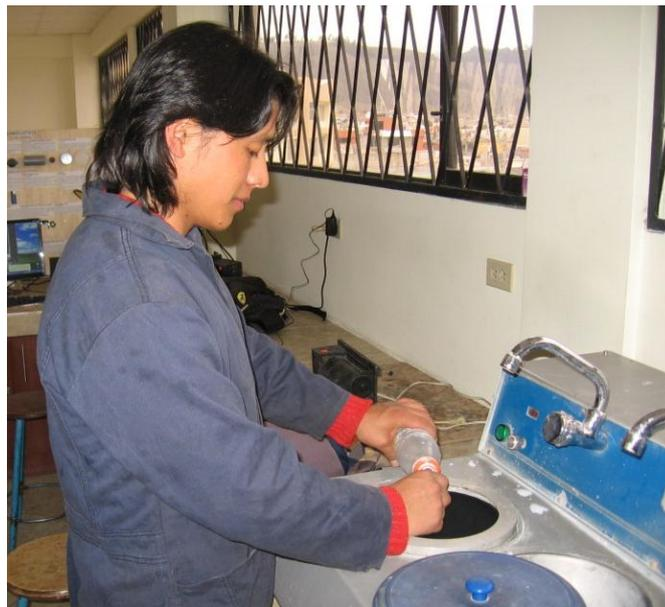
**Figura 6.9: Paso de la probeta por el banco de lijas**
