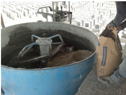
Ilustración 36: Fabricación de bloque 1 Fuente: Archivo Juan Ulloa
