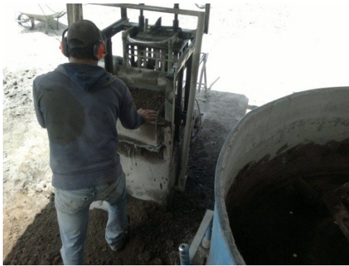
Ilustración 40: Fabricación de bloque 5 Fuente: Archivo Juan Ulloa
