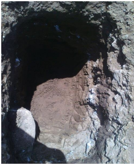
Calicata para la extracción del suelo
