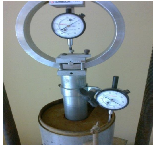
Ensayo de penetración
