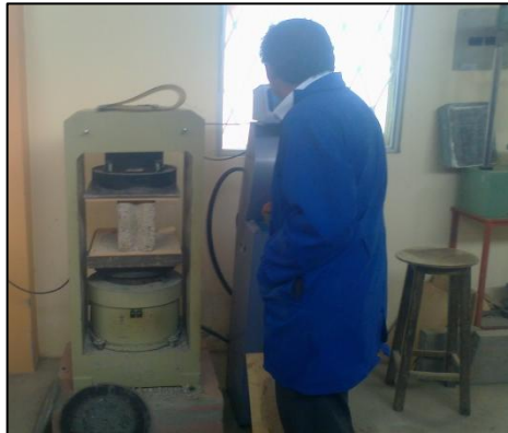
Imagen 9. Ensayo de bloques en la máquina de compresión
