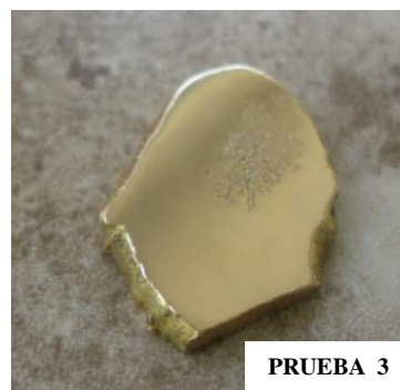
Figura 12. Probeta (A) Prueba 3 tomada de una muestra regada, se observa agrietamientos, posiblemente debido al contacto con el suelo. (Fuente: El autor)
