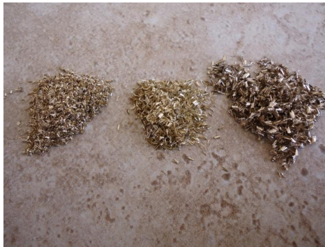
Figura 58. Se compara la viruta de las 2 primeras pruebas a más de eso la viruta con profundidad de 4.5mm que se realizó luego de las pruebas de maquinabilidad. (fuente el autor).
