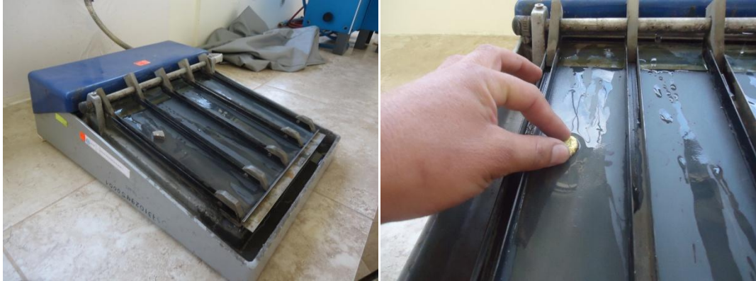
Figura 82. Pulido de la probeta antes del análisis químico en el banco de lijas (Fuente: el autor)
