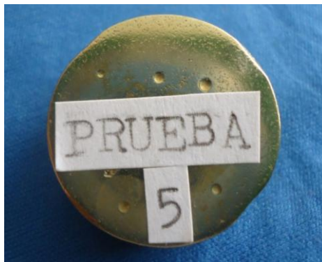
Figura 30. Probeta para ensayo de microestructura prueba 5, (Fuente: el autor)
