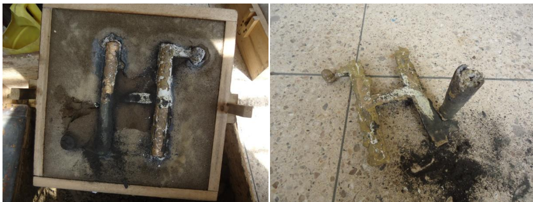
Figura 79. Extracción de la aleación compuesta Cu, Zn y Pb de la caja de moldeo (Fuente: el autor)
