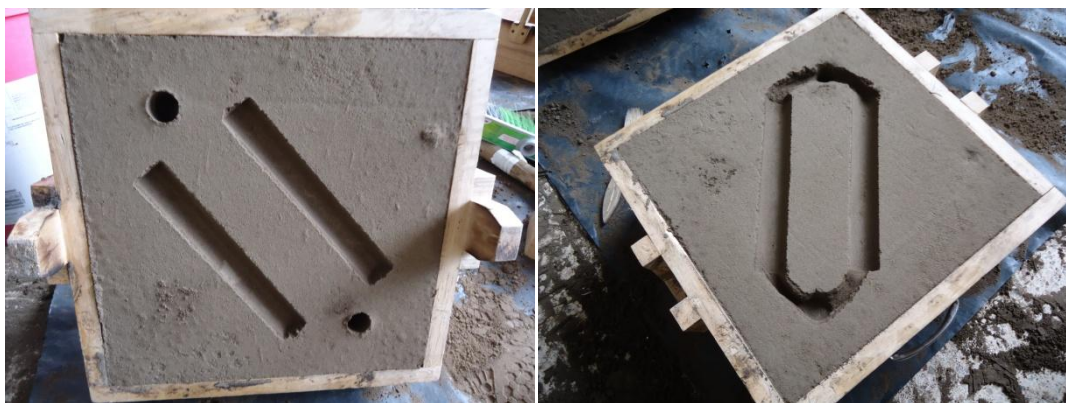
Figura 68. Las dos partes de la caja una vez extraídos los moldes y bebederos y realizado los canales de distribución de la colada (Fuente: el autor).
