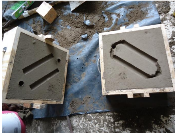
Figura 69. Caja lista para el secado con mechero a gas (Fuente: el autor)
