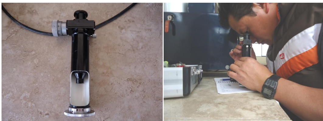
Figura 89. Microscopio para medir el diámetro de la impresión y toma de medida de las impresiones (Fuente: el autor)
