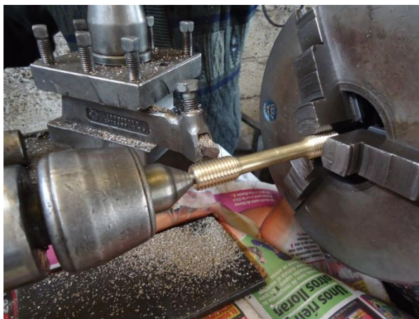
Figura 81 . Maquinado de probetas en el torno y probeta lista para el ensayo a tracción maquinada según la norma ASTM E-8 . (Fuente: el autor)
