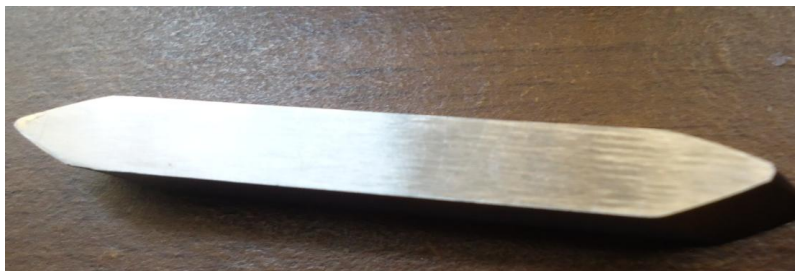
Figura 51. Cuchilla de acero rápido de \frac{1}{4} \times 2 \frac{1}{2} HSS Rc66 afilada en sus dos extremos. (fuente el autor).
