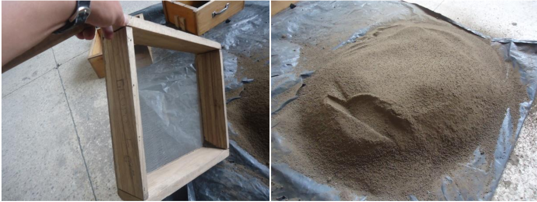
Figura 63. Tamizado de arena y arena fina lista para la primera capa de llenado del molde (Fuente: el autor)
