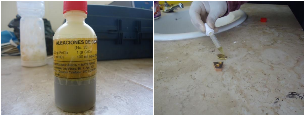
Figura 84. Reactivo químico para aleaciones de cobre con su composición química: 20 gr de \text{FeCl}_3 , 5 ml de \text{HCl} , 1 gr de \text{CrO}_2 , y 100 ml de agua destilada y ataque químico en las probetas (Fuente: el autor)
