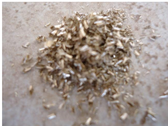
Figura 55. Viruta que se obtuvo al maquinar con una profundidad de corte de 4.5mm. (fuente el autor).
