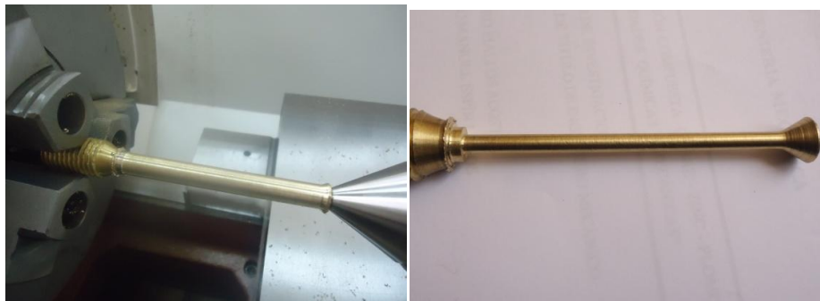
Figura 57. En la primera fotografía se observa el acabado con la primera pasada, y en la segunda, el acabado luego de la última pasada (fuente el autor).
