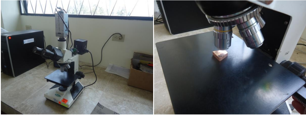
Figura 85. Microscopio utilizado para análisis metalográfico y la probeta en observación (Fuente: el autor)
