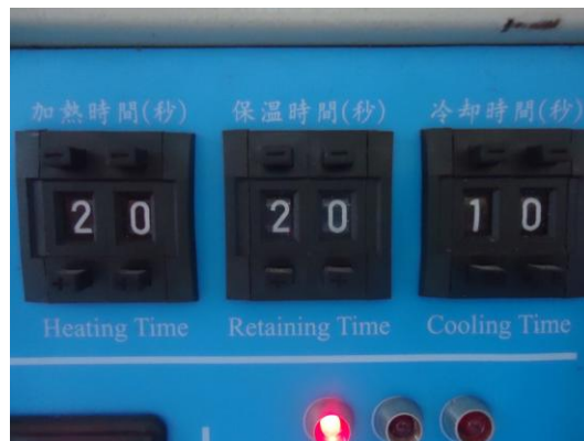
Figura 75. Pantallas de los tiempos de Calentamiento, Retención y Enfriamiento respectivamente del horno de inducción del laboratorio de fundición de la FICM-UTA (Fuente: el autor)
