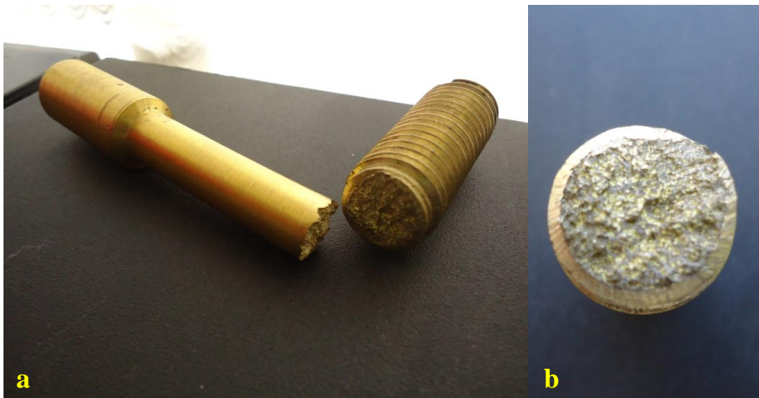
Figura 35a. ruptura de la probeta al momento de maquinar la rosca, figura 35b. Vista del tamaño de grano muy grueso (Fuente: el autor)
