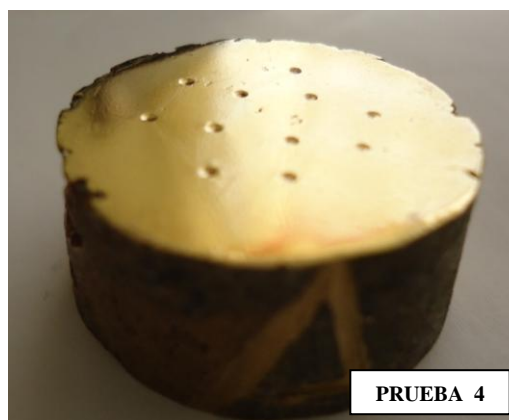
Figura 19. Probeta (A) prueba 4, tomada del bebedero de entrada, luego del ensayo de microestructura y de dureza (Fuente: el autor)
