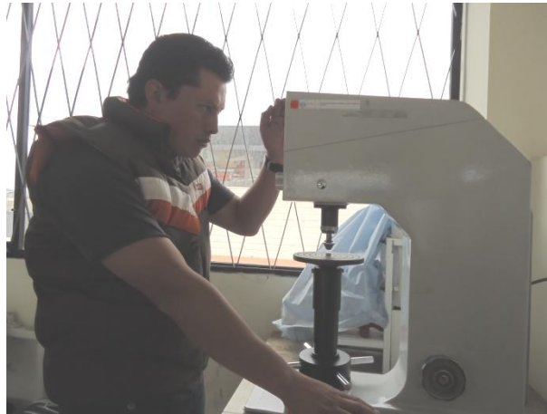
Figura 88. Impresión de las huellas en el durómetro de la FICM – UTA (Fuente: el autor)
