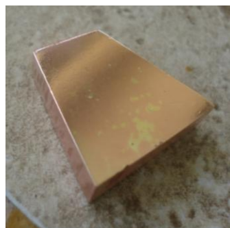
Figura 87. Probeta lista para el ensayo de dureza (Fuente: el autor)
