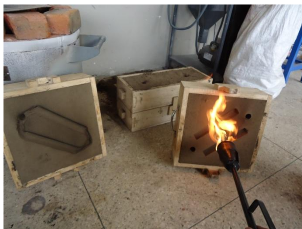
Figura 70. Secado de la arena con el mechero a gas para evitar porosidad en el material (Fuente: el autor).
