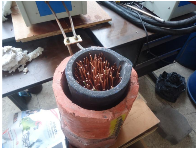
Figura 59. Crisol de grafito arcilla A6 sobresale la bobina del horno de inducción (Fuente: el autor)
