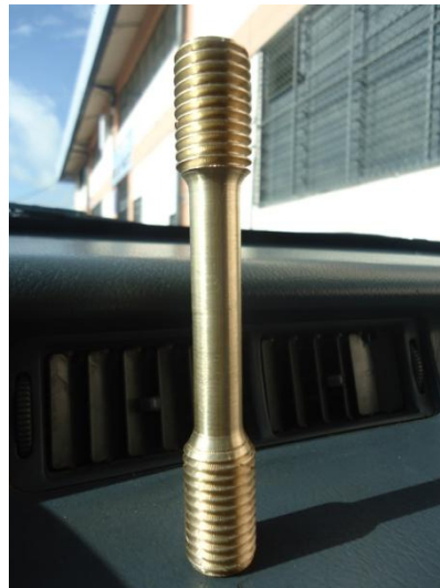
Figura 81 . Maquinado de probetas en el torno y probeta lista para el ensayo a tracción maquinada según la norma ASTM E-8 . (Fuente: el autor)
