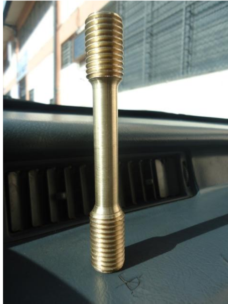
Figura 24. Probeta 4.1 para ensayo de tracción según norma ASTM-8. (Fuente: el autor)
