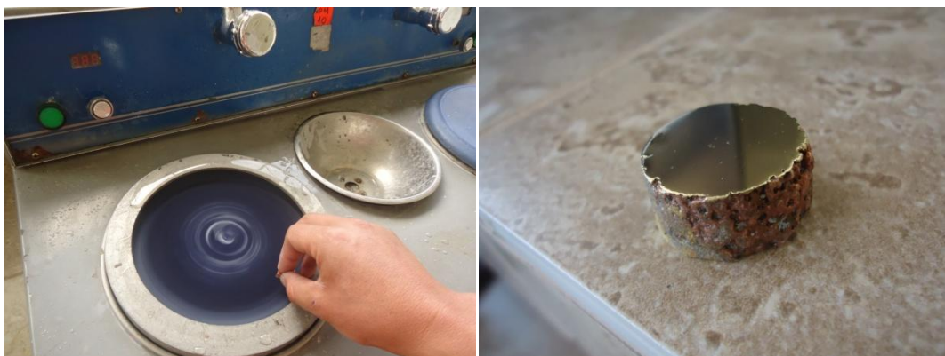
Figura 83. Pulido de la probeta en el paño y probeta lista para el ataque químico (Fuente: el autor)
