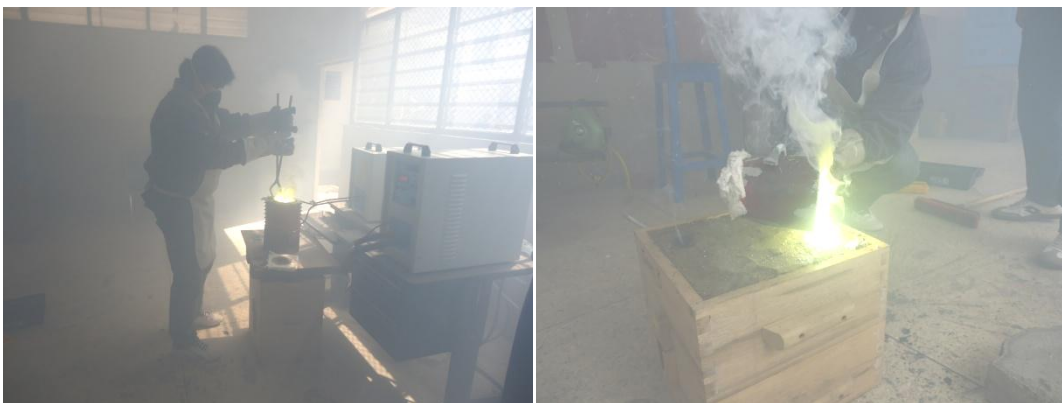
Figura 78. Extracción del crisol y llenado en el molde de arena. (Fuente: el autor)
