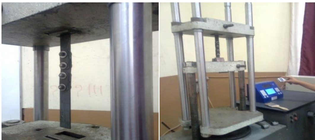
Figura 6. Máquina Universal para ensayos de Tracción, gentileza de la FICM de la Universidad Técnica de Ambato. (Fuente: El autor)
