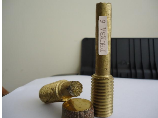
Figura 39. Probeta prueba 6 ensayada a tracción (Fuente: el autor)
