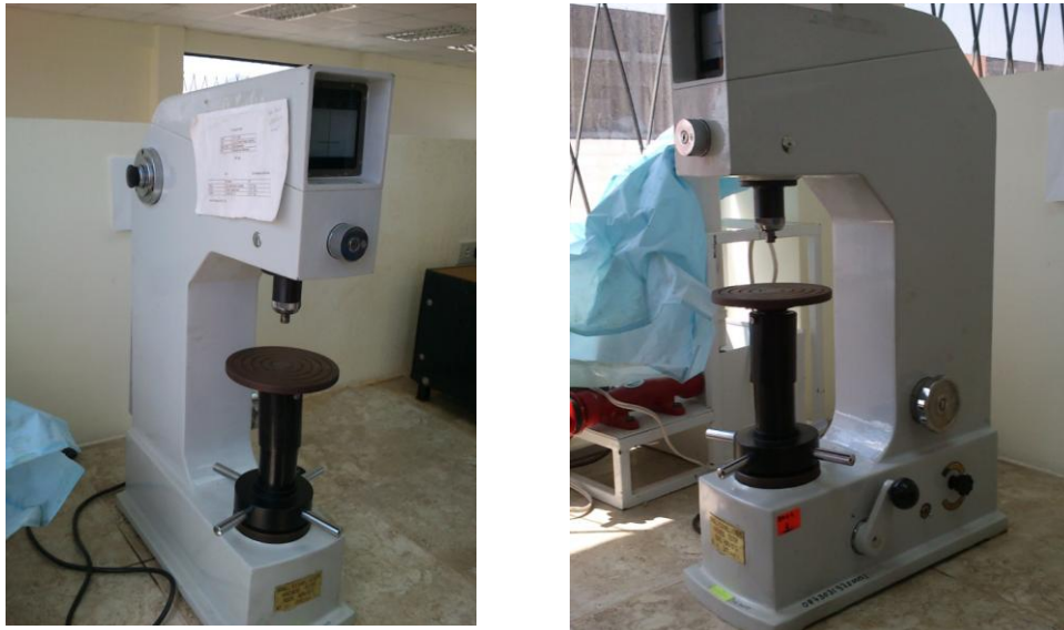
Figura 9. Durómetro de metales electrónico, gentileza de la facultad de ingeniería civil y mecánica del laboratorio de materiales de la UTA (Fuente: el autor)
