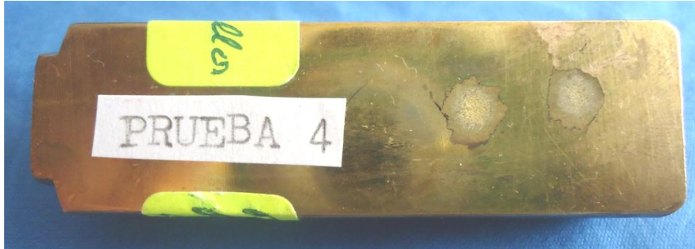
Figura 27. Ensayo químico de análisis por Espectrometría de Chispa de la prueba 4 (Fuente: el autor)
