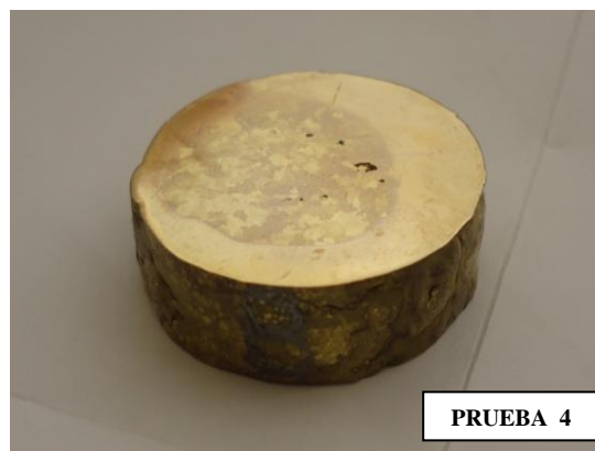
Figura 23. Probeta (B), tomada del bebedero de salida con ataque químico (Fuente: el autor)
