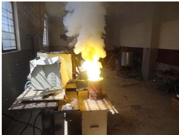
Figura 77. Reacción química con desprendimiento de óxido de Zinc (Fuente: el autor)
