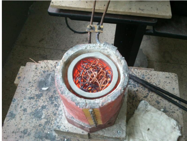
Figura 76. Crisol A6 preparado con el cobre apunto de fundirse en la bobina del horno a inducción (Fuente: el autor)
