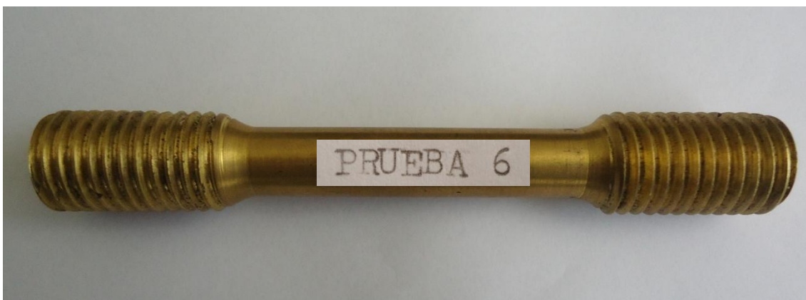
Figura 36. Probeta A de la prueba 6 para ensayo de tracción según norma ASTM-8. (Fuente: el autor)
