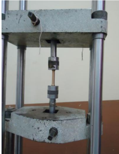
Figura 37. Máquina universal de la Facultad de Ingeniería Civil y Mecánica, para ensayo de tracción según norma ASTM-8. (Fuente: el autor)
