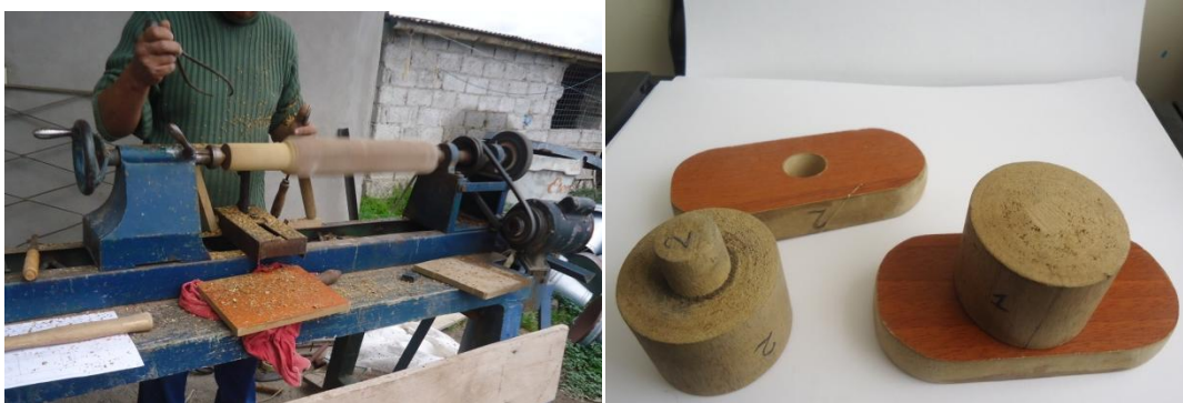
Figura 91. Fabricación de los moldes de madera para la aplicación industrial (Fuente: el autor)
