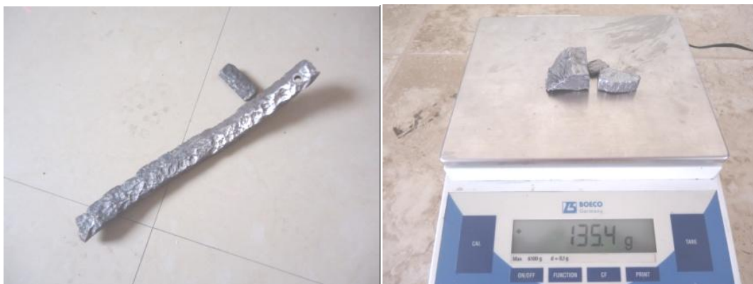
Figura 73. Lingote de plomo y pesaje del material cortado (Fuente: el autor)
