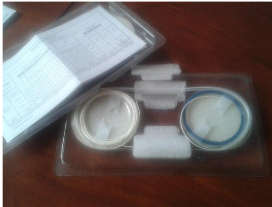
Figura 6.46: Splitter PLC 1x8 Fuente: Investigador
