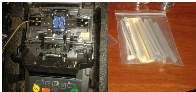
Figura 6.29: Colocación de hilos y tubillos de fusión Fuente: Investigador
