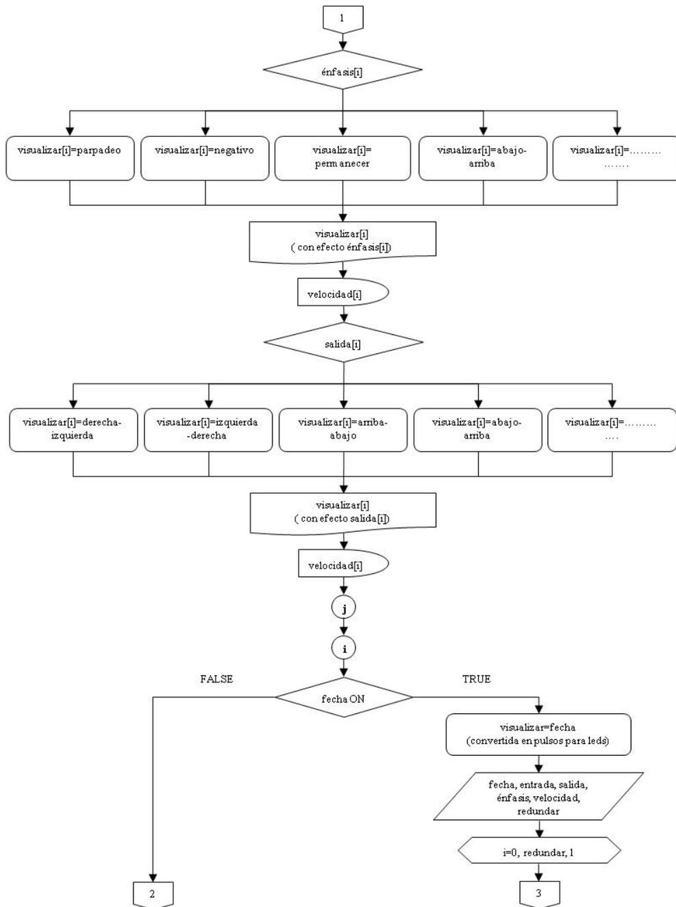
Figura No 6.23. Diagrama de flujo de la programación del PIC16F877A (2 de 5)
