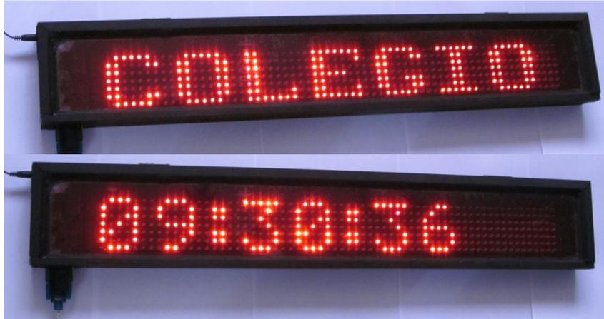
*Figura No 6.38. Funcionamiento del letrero electrónico (con gabinete)
