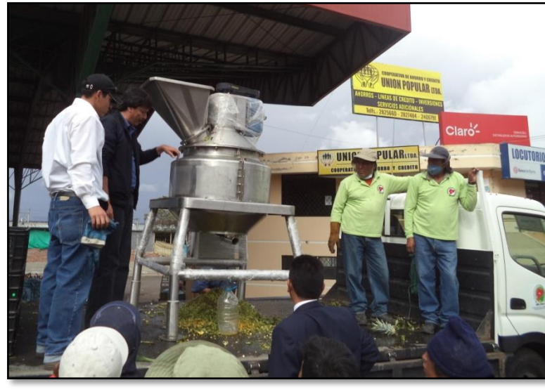
Figura O.1. Pruebas de Funcionamiento del Triturador en la EP-EMA.
