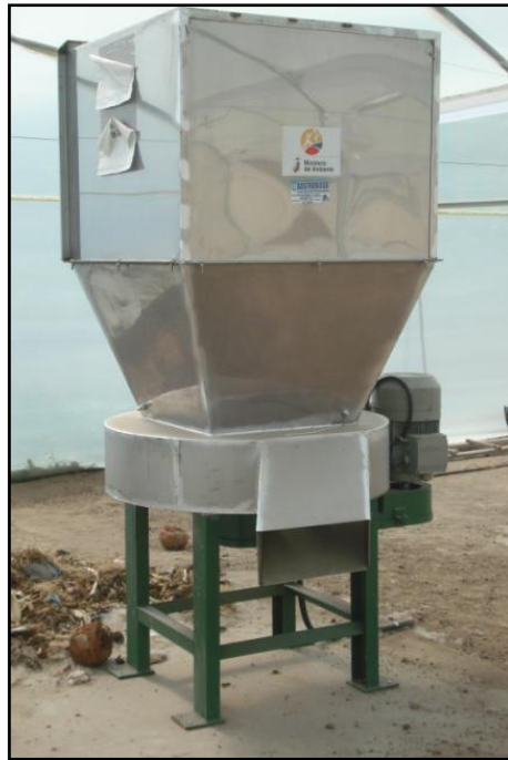
Figura A. 3 Picadora de Residuos Orgánicos de la Planta de Clasificación y Recuperación en el Cantón Salcedo.
