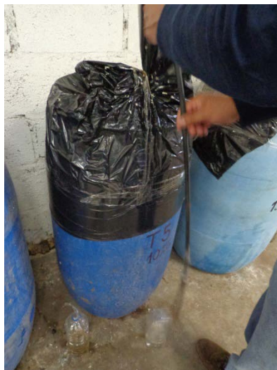
Foto B13: Sellado hermético de los biodigestores y colocación de la trampa de agua
