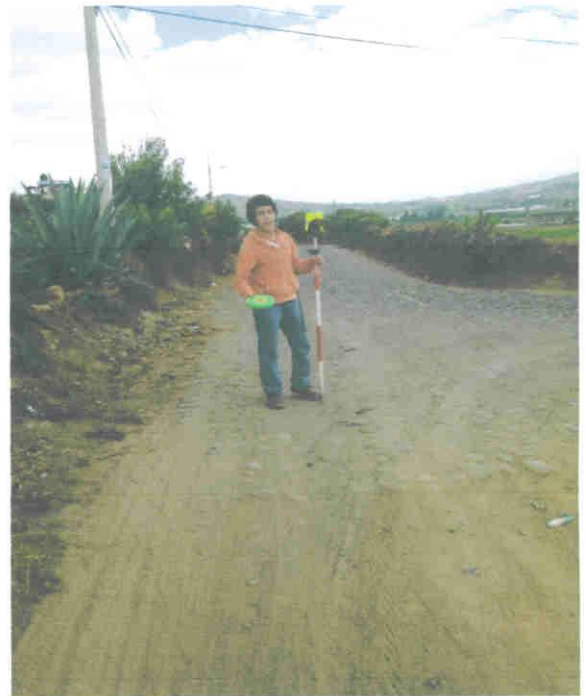
Calle los Llanganates (con los equipos que son cinta, jalón)
