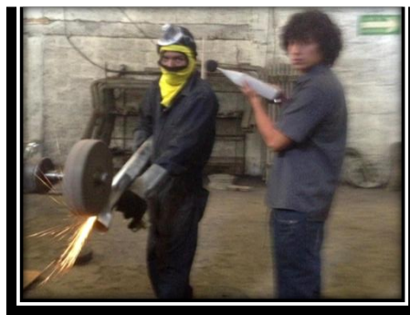
Fig. 25: Medición de ruido Pulidor- Área de Mecánica I.
