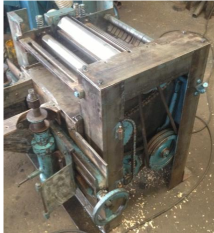
Fig. 39: Mantenimiento Cepilladora - Área de Carpintería.
