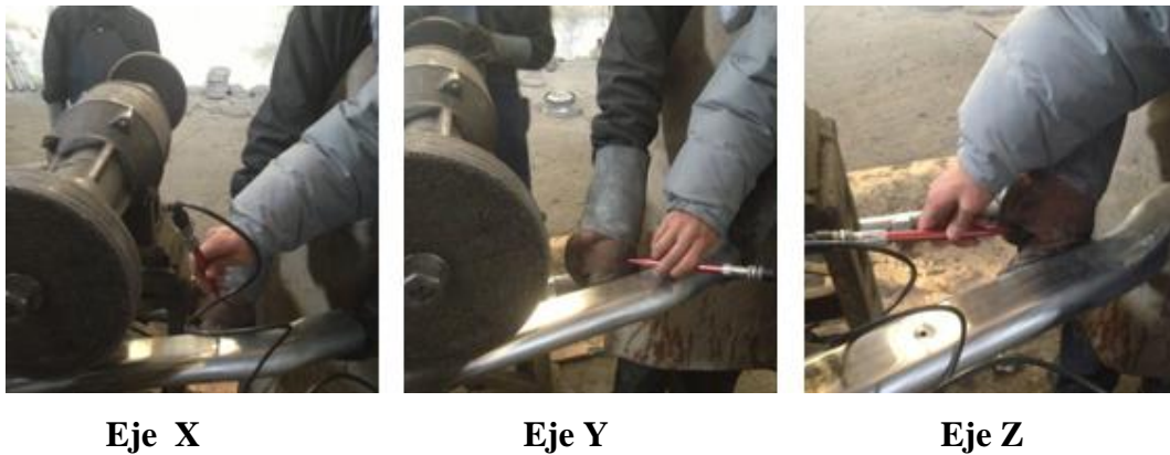
Fig. 32: Medición basicéntrica (mano –brazo) Pulidor - Área de Mecánica I. Elaborado: Pazmiño Jonathan.
