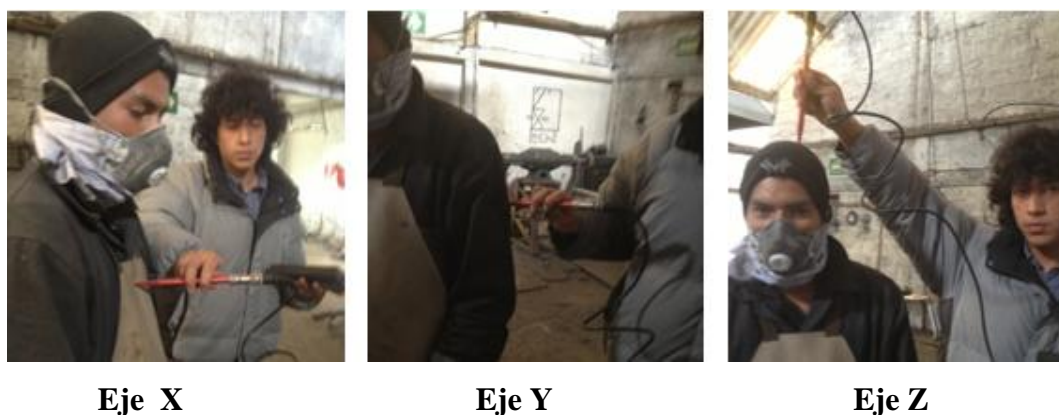
Fig. 33: Medición de vibración (cuerpo completo) Pulidor-Área de Mecánica I. Elaborado: Pazmiño Jonathan.
