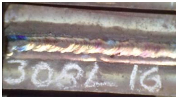
Figura 6. 36.- Probeta soldada para ensayo de impacto.
