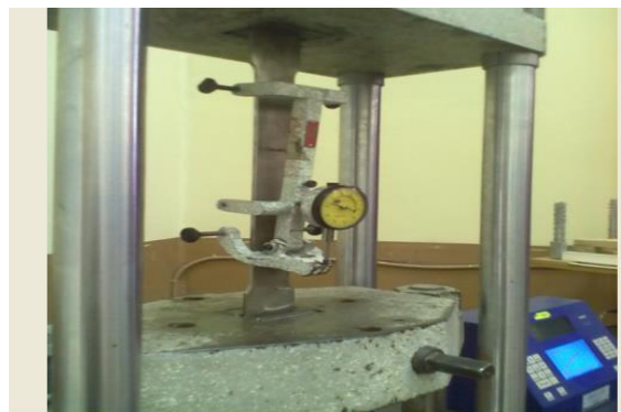
Figura 6. 22.- Acople del deformímetro para el ensayo.
