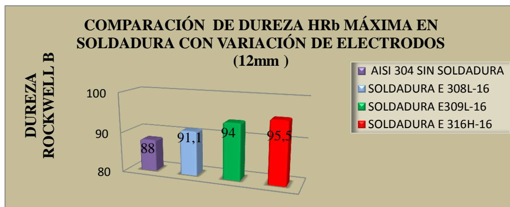
Figura 4. 8.- Comparación de dureza Rockwell b (HRB), en un proceso de soldadura SMAW. A 12 mm del centro del cordón con variación de electrodos (FUENTE: Willian Naula).
