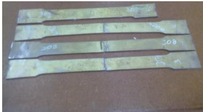
Figura 6. 26.- Deformación de la probeta en la junta.
