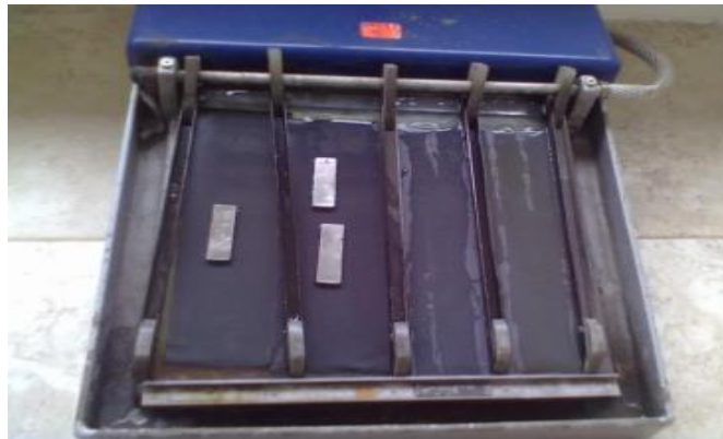
Figura 6. 47.- Lijas para desbaste y lijado medio de la superficie.
