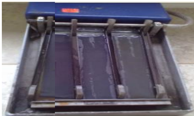
Figura 6. 48.- Lijas para refinado de la superficie.
