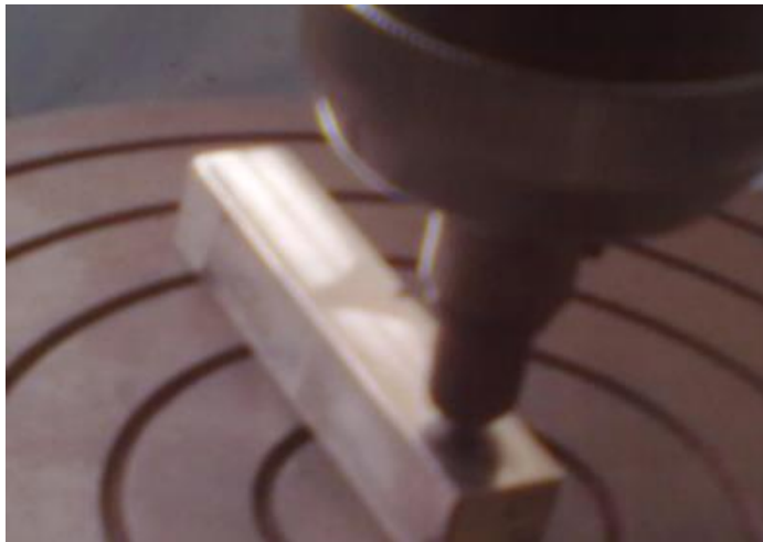
Figura 6. 34.- Ensayo de dureza a partir del centro del cordón de la soldadura.
