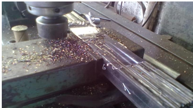
Figura 6. 15.- Maquinado de probetas según especificaciones ASTM E8.
