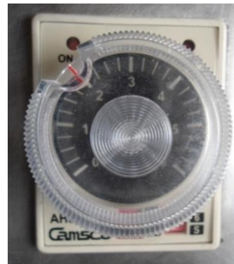
Figura 6.10. Control de tiempo por medio de un timer o cronometro
