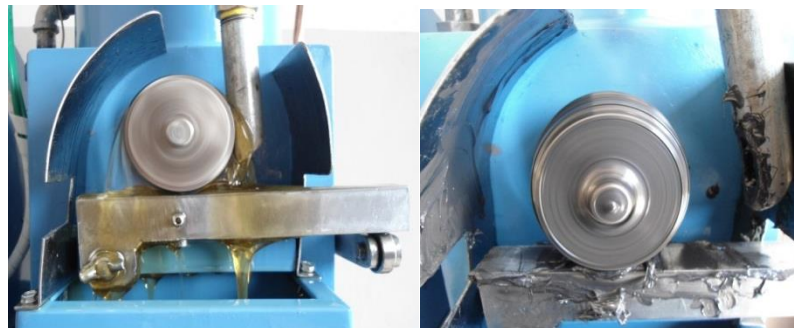
Figura 6.8. Control de la capa lubricante.
