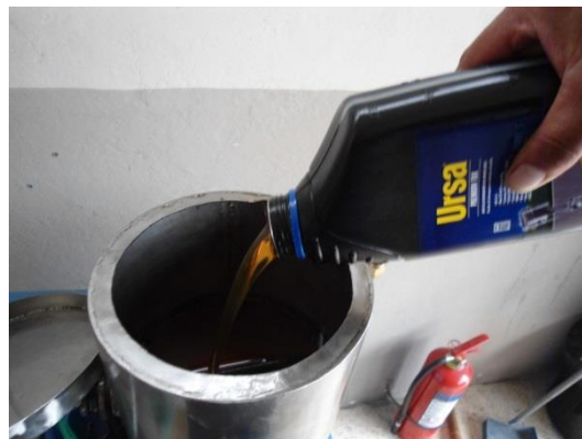
Figura 6.6. Colocación del aceite a ensayar.
