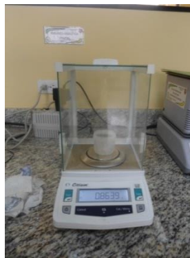
Figura 6.2. Pesado de los rodamientos 6202 y NJ202
