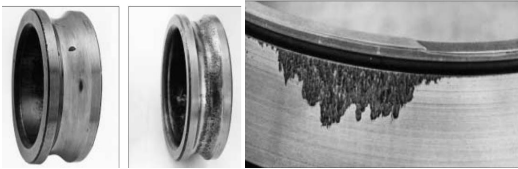
Figura 2.7 Huellas de rodadura por fatiga
