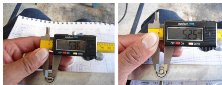
Figura 6.15. Longitud máxima de la huella en el rodamiento NJ202 y 6202
