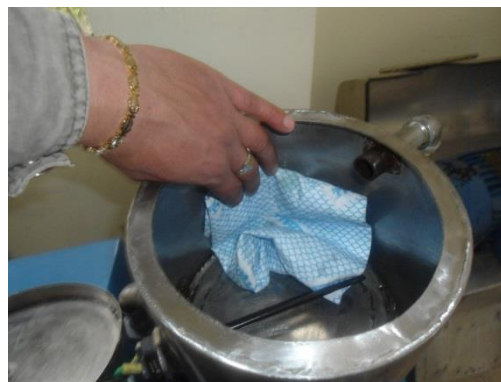
Figura 6.5. Limpieza del tanque de aceite.
