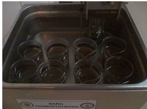
Control de la temperatura con en el baño termostático
