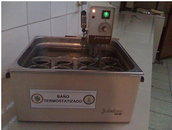
Control de la temperatura con en el baño termostático
