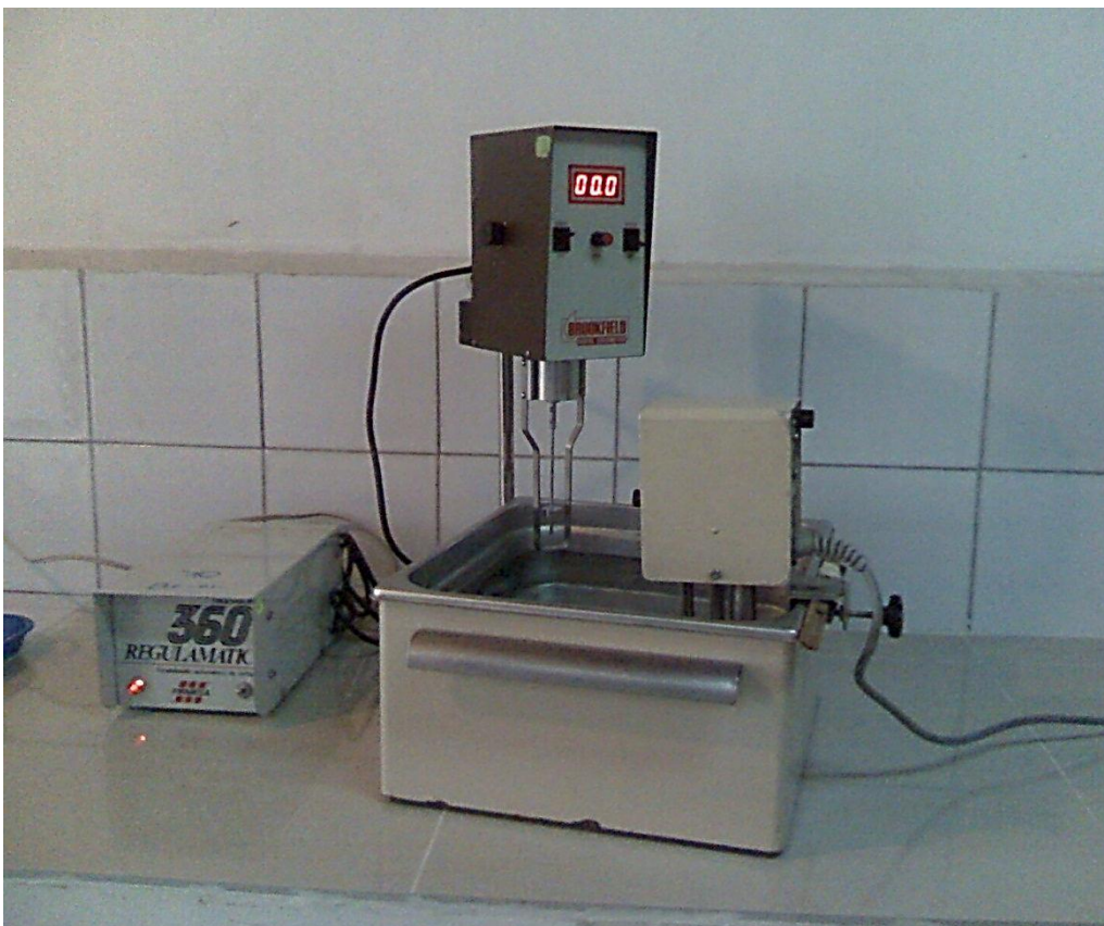
Figura 4. Viscosímetro Brookfield LVTD con accesorios para control de temperatura.
