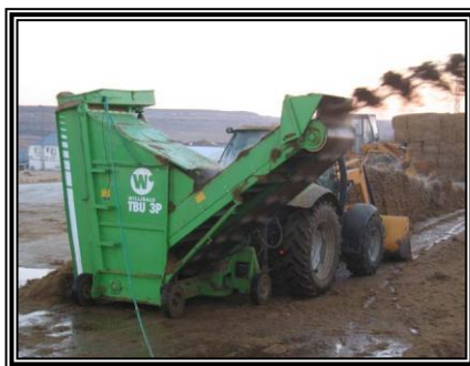
Fig. 2.25: Volteadora lateral (Marca Willibald TBU 3P) Fuente: Características de la volteadora Willibald TBU 3P http://nexodesign.net
