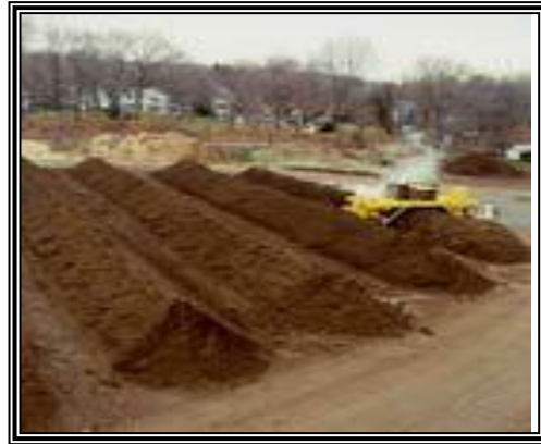
Fig. 2.15: Formación de pilas triangulares Fuente: Manual de compostaje para Municipios www.ded.org.ec iml@loja.telconet.net
