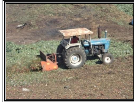
Fig. 4.26: Trituradora en funcionamiento Fuente: El autor
