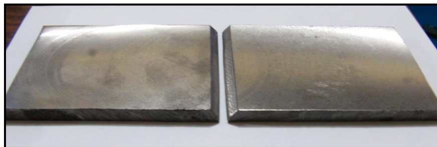
Figura 6.20: Hierro fundido gris clase 30, Junta Fresada con un espesor de 8 [mm]
