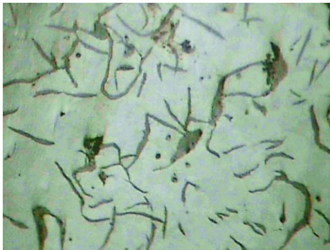
ZONA TÉRMICAMENTE AFECTADA 200X, NITAL 2, 2 SEG.
