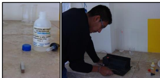
Figura 6.8: Ataque Químico y secado de probetas Fuente: Autor
