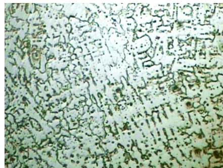
Metal Fundido, AWS A5.15, ENi-CI 100X, Reactivo Níquel – Cobre 38, 6 Seg
