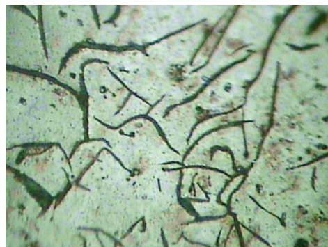
ZONA TÉRMICAMENTE AFECTADA 200X, NITAL 2, 3 SEG.
