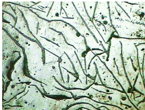
ZONA TÉRMICAMENTE AFECTADA 100X, Nital 2, 3 Seg.
