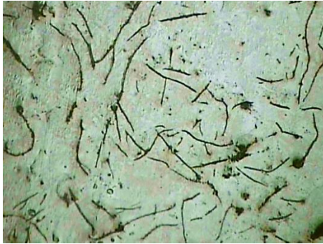
ZONA TÉRMICAMENTE AFECTADA 100X, NITAL 2, 4 SEG.
