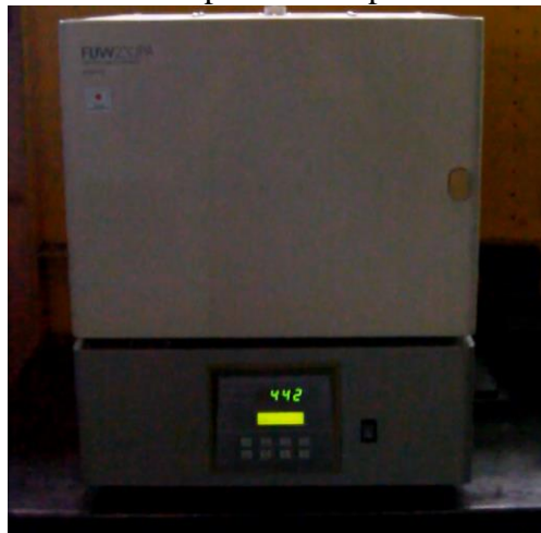
Figura 6.24: Pre calentamiento de probetas en horno
