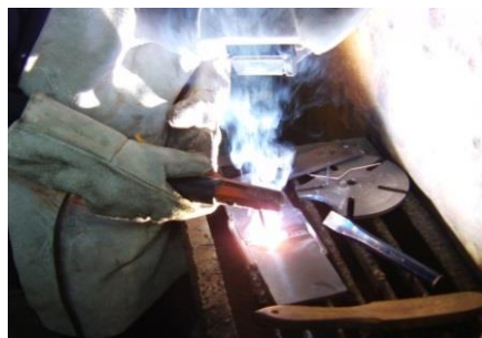
Figura 6.27: Soldadura de probetas Fuente: Autor
