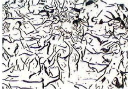
Figura 2.11 Hojuelas de grafito en el hierro fundido gris.
