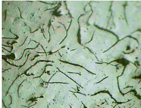
ZONA TÉRMICAMENTE AFECTADA 100X, NITAL 2, 7 SEG.
