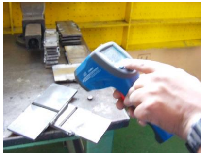
Figura 6.26: Control de temperatura mediante el pirómetro Fuente: Autor
