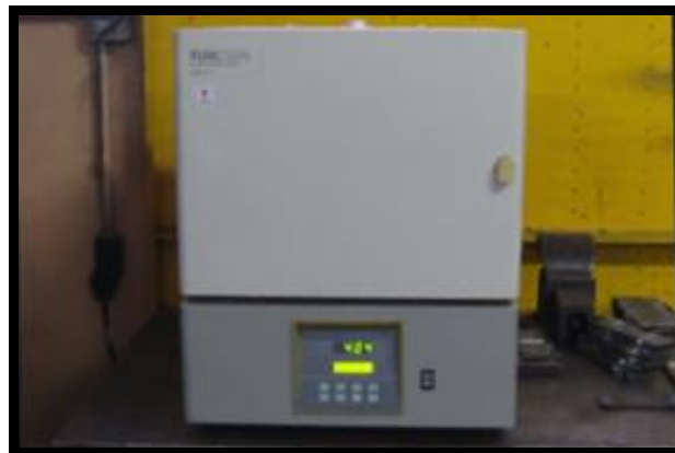
Figura 6.22: Horno de resistencias eléctricas Fuente: Autor
