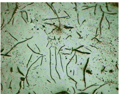
ZONA TÉRMICAMENTE AFECTADA 100X, NITAL 2, 9 SEG.
