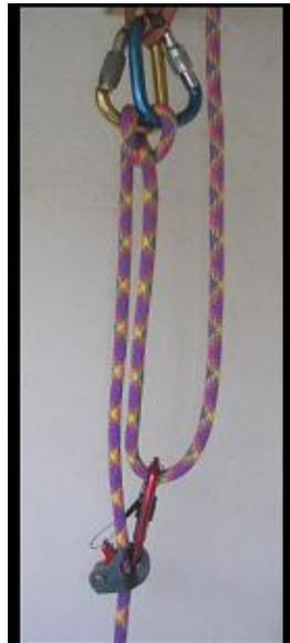
Figura 4-26 Polipasto realizado con un ropeman
