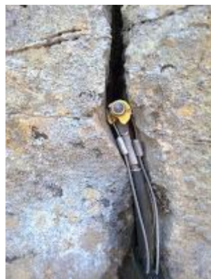
Correcta colocación del friend
