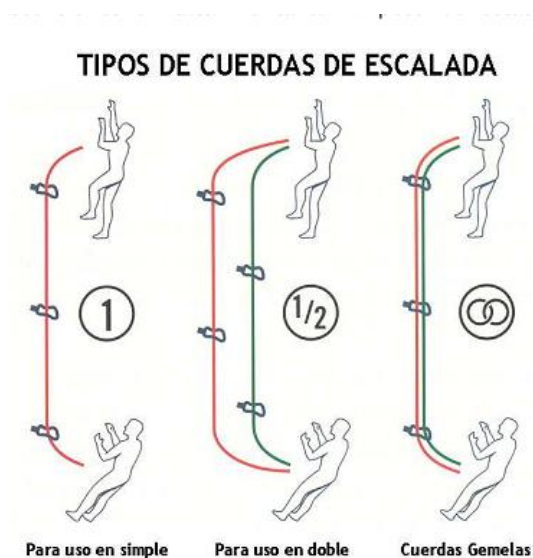
Figura 3-3 Tipos de cuerda de escalada
