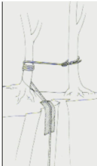
Figura 6-1 Anclaje Natural empleando arboles
