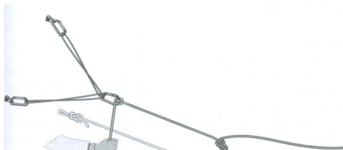
Figura 7-2 Tirolesa individual doble polea en línea individual
